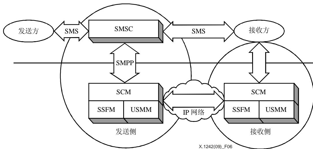
图 6 – 发送侧传递模式中的垃圾短消息过滤
