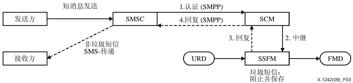
图 5 – 接收侧传递模式中的垃圾短消息过滤系统的过程
