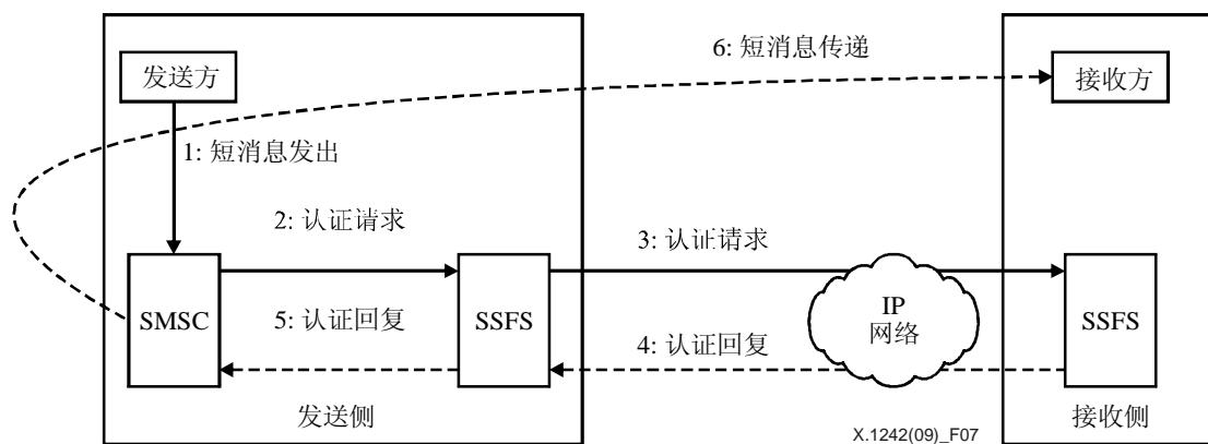
图 7 – 发送侧传递模式中的垃圾短消息过滤过程
