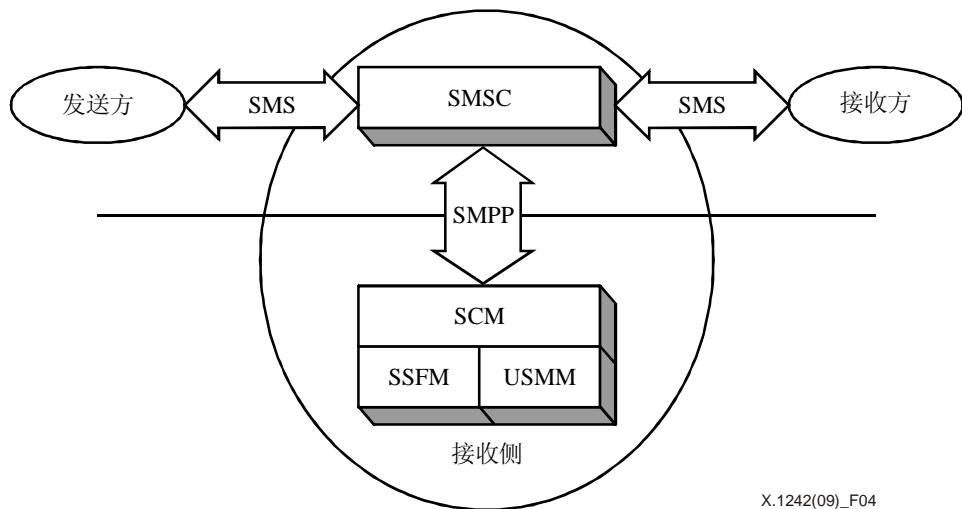
图 4 – 接收侧传递模式中的垃圾短消息过滤
