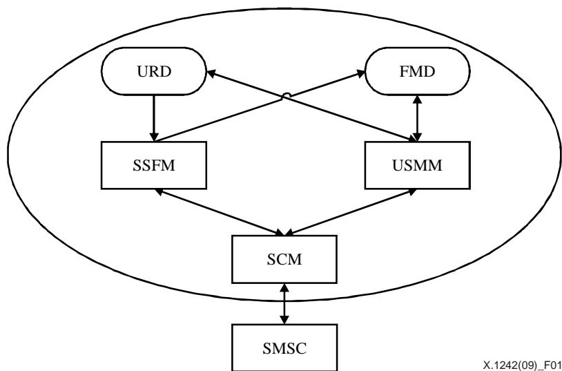
图 1 – 垃圾短消息过滤系统的结构
