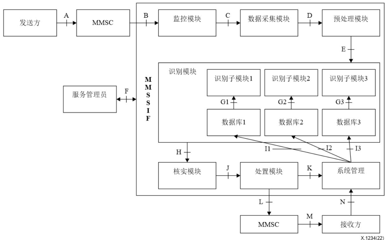
图 8-3 – 打击MMS垃圾信息的参考模型
