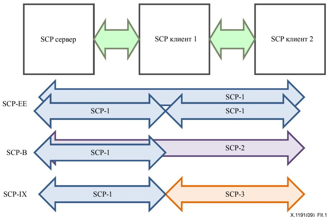
Рисунок II.1 – Режим функциональной совместимости систем SCP
