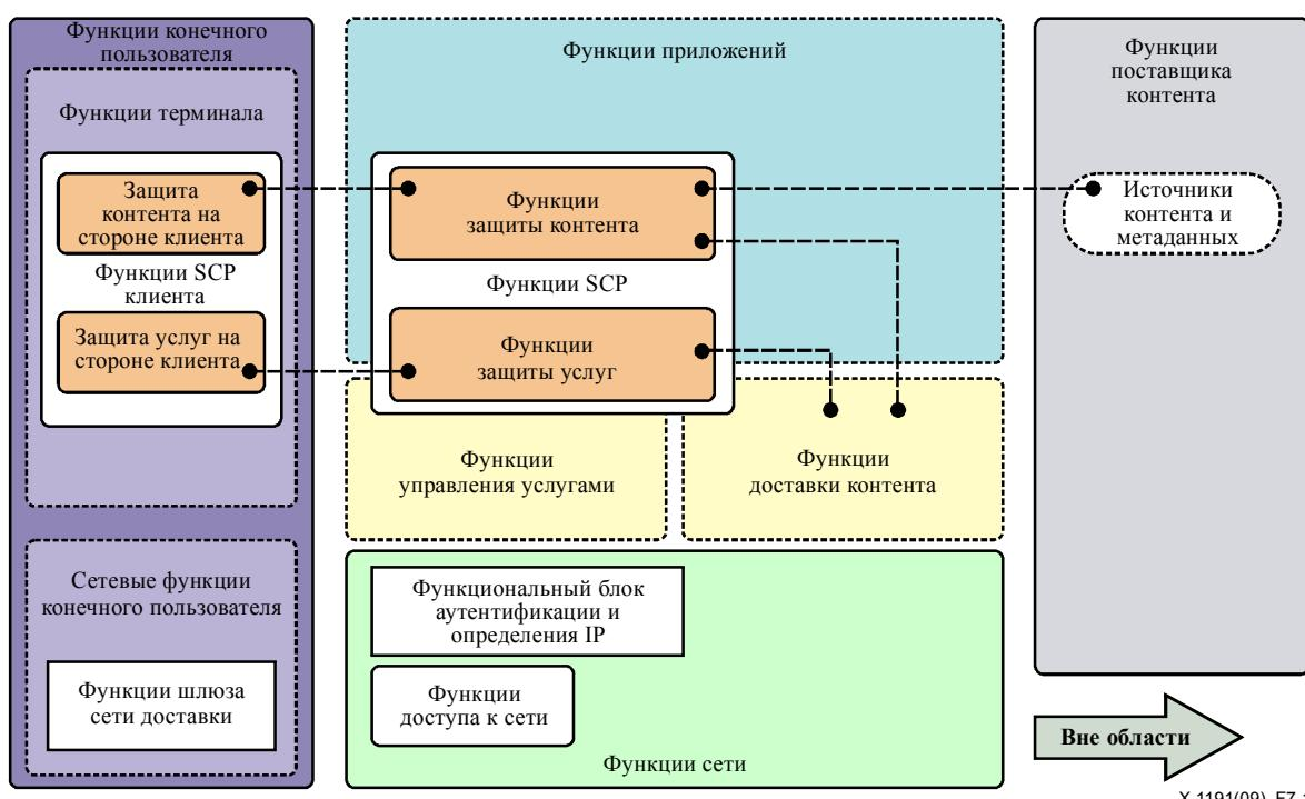
**ПРИМЕЧАНИЕ 1.** – Функции защиты контента и функции защиты услуг на этом рисунке являются наиболее важными элементами архитектуры безопасности IPTV. Подробное описание этих функций можно найти на рисунке 7-2 (*Архитектура защиты контента*) и рисунке 7-3 (*Архитектура защиты услуг*).
