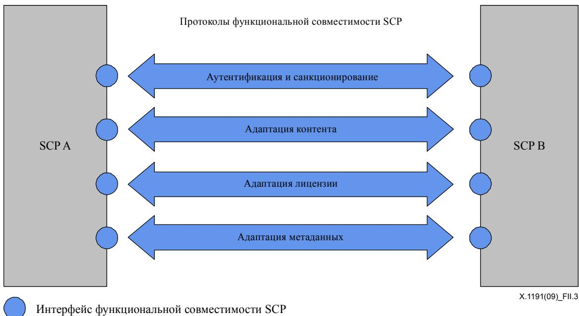
**Рисунок II.3 – Архитектура обеспечения функциональной совместимости на основе стандартного протокола**
