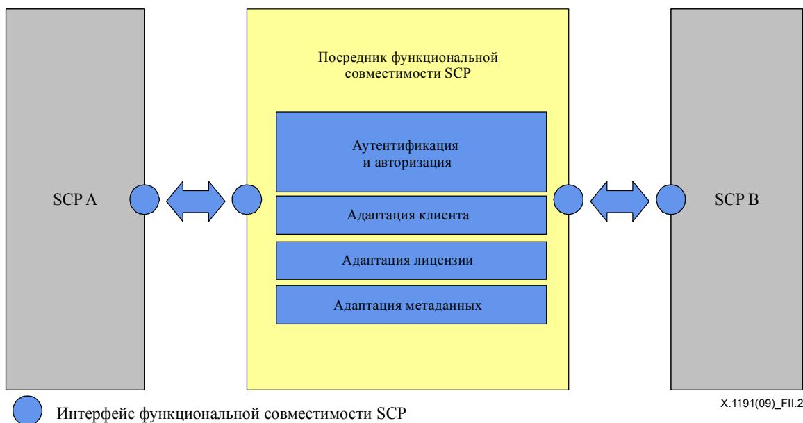
**Рисунок II.2 – Архитектура обеспечения функциональной совместимости с помощью посредника**
