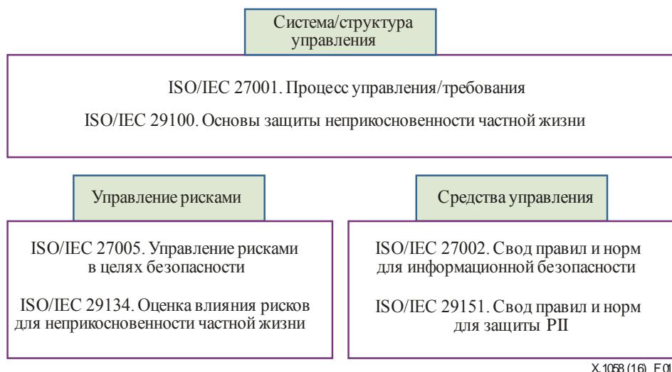
**Рисунок 1 – Связь между настоящей Спецификацией и семейством стандартов ИСО/МЭК**
