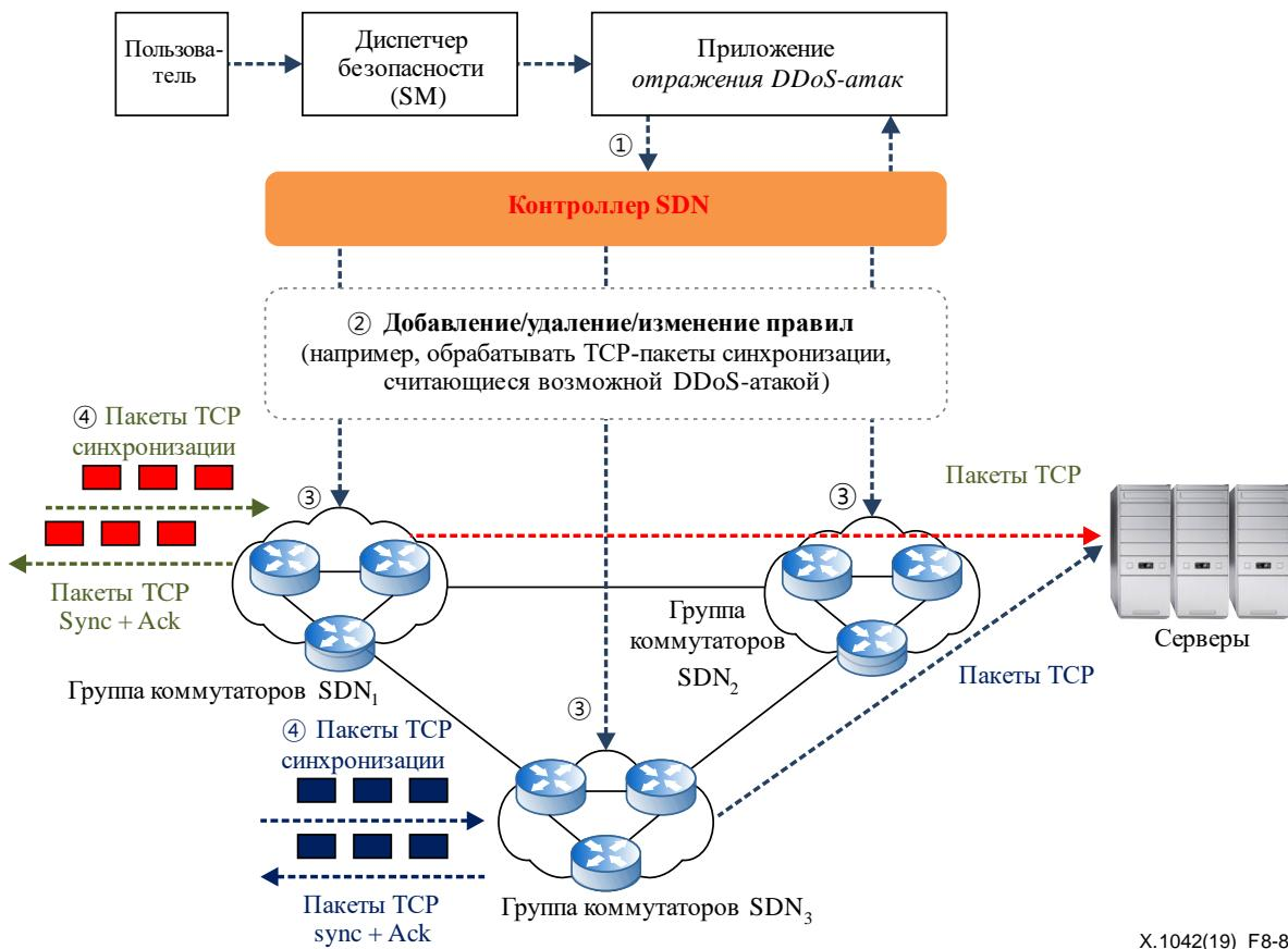
**Рисунок 8-8 – Сценарий работы междоменной централизованной службы отражения DDoS-атак для серверов, фиксирующих данные о запросах**
