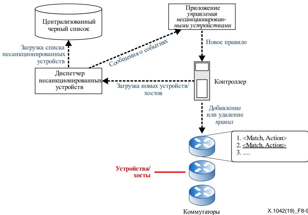
Рисунок 8-9 – Концепция централизованной службы управления несанкционированными устройствами
