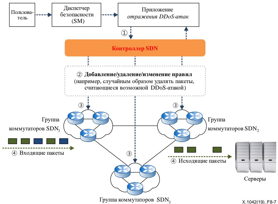
**Рисунок 8-7 – Сценарий работы междоменной централизованной службы отражения DDoS-атак для серверов, не фиксирующих данные о запросах**
