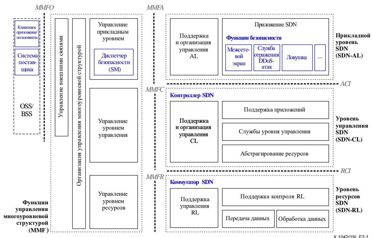
Рисунок 7-1 – Сетевые ресурсы служб безопасности на основе SDN
