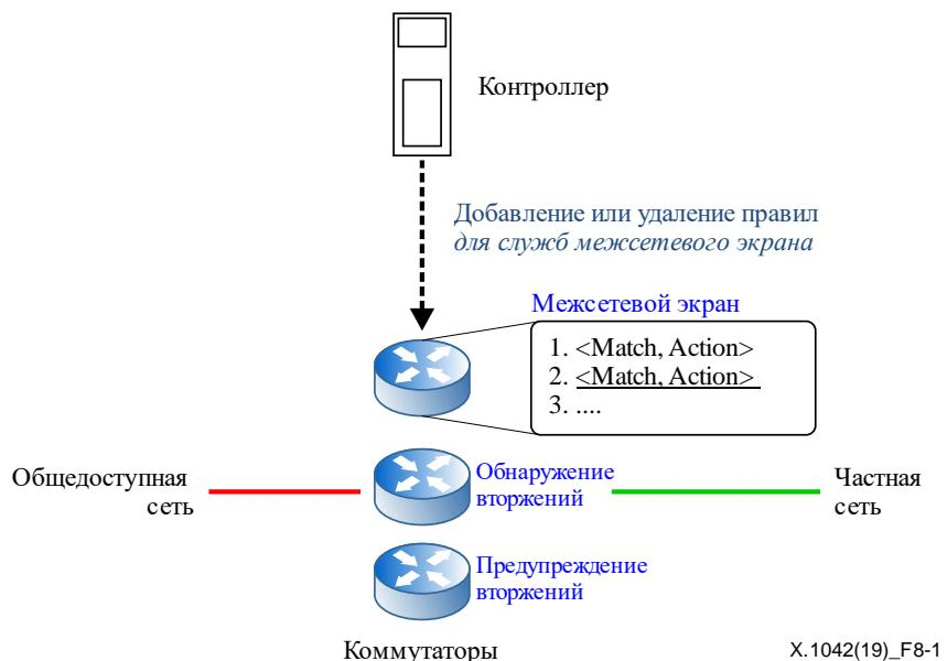
Рисунок 8-1 – Концепция централизованной службы межсетевого экрана
