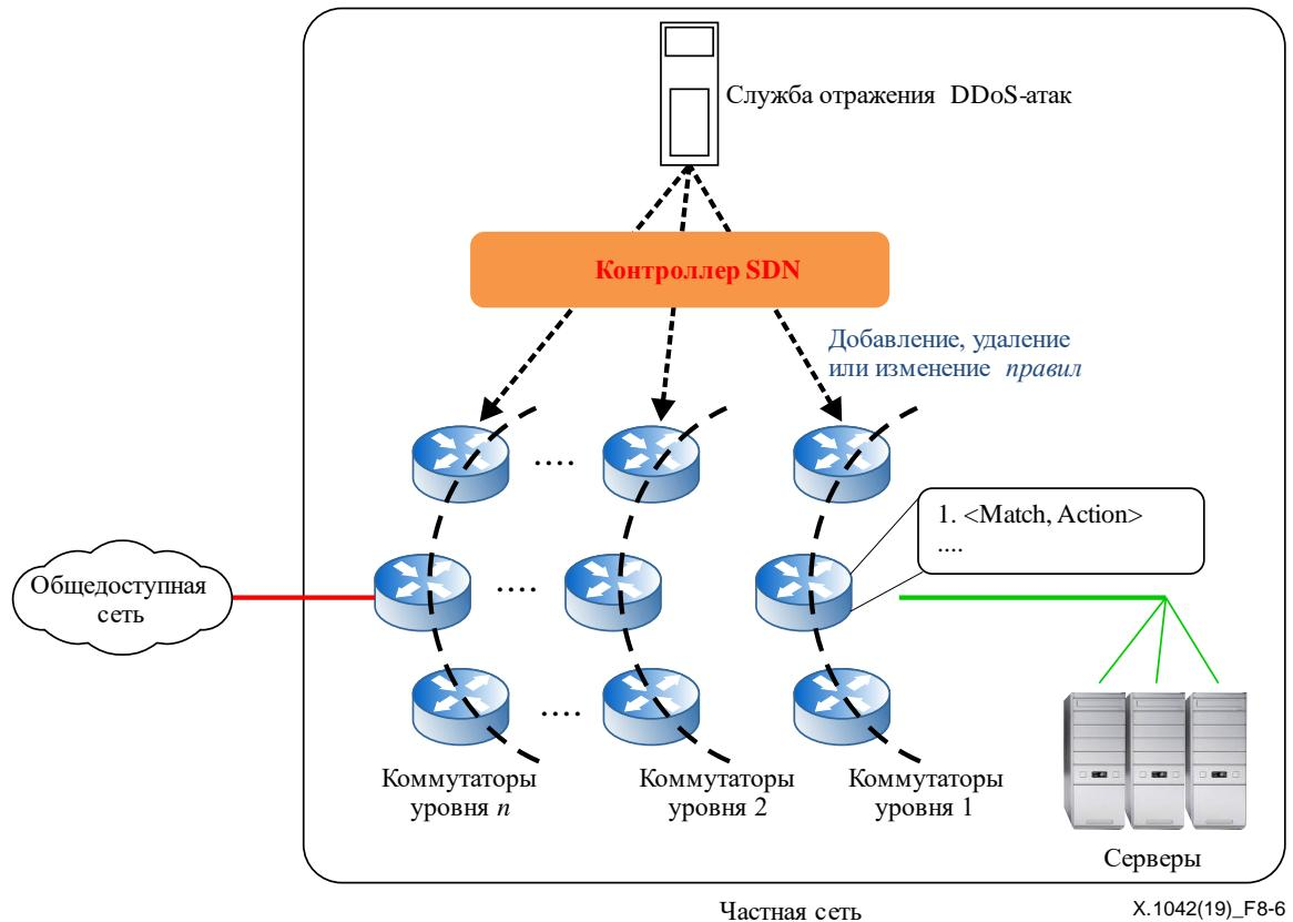
Рисунок 8-6 – Концепция централизованной службы отражения DDoS-атак
