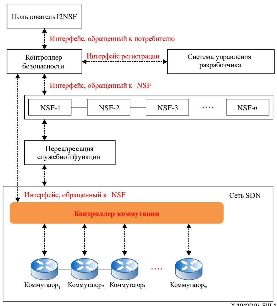
Рисунок III-1 – Структура интерфейса для функций защиты сети в стандарте IETF
