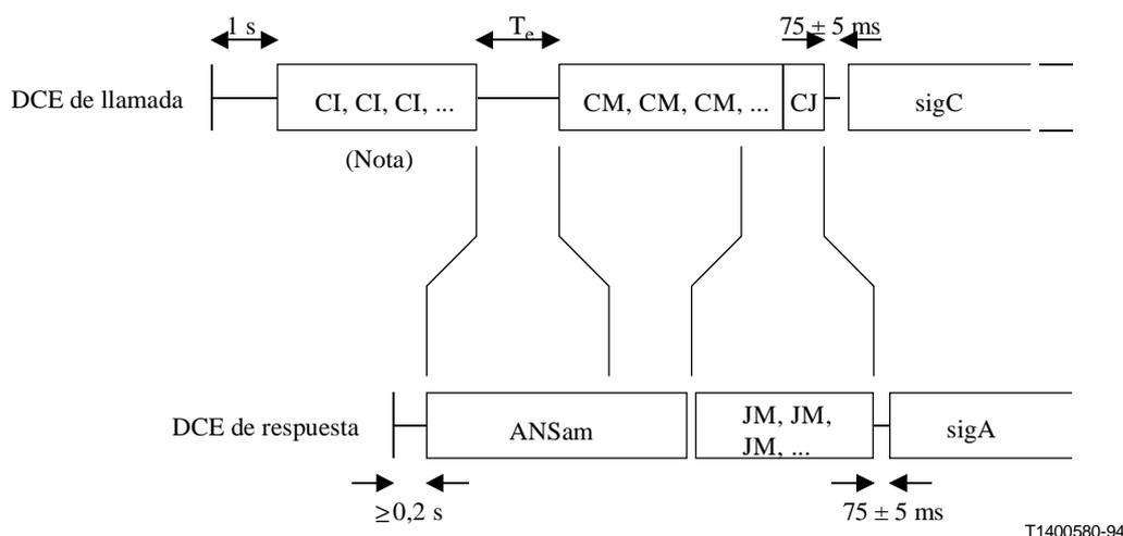
**Figura 1/V.8 – Utilización de la señal de llamada CI e intercambio de señales de menú CM/JM**
