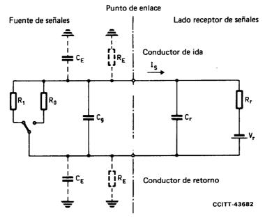
$R_1$  = resistencia interna de la fuente de señales (contacto cerrado)  $R_0$  = resistencia interna de la fuente de señales (contacto abierto)
