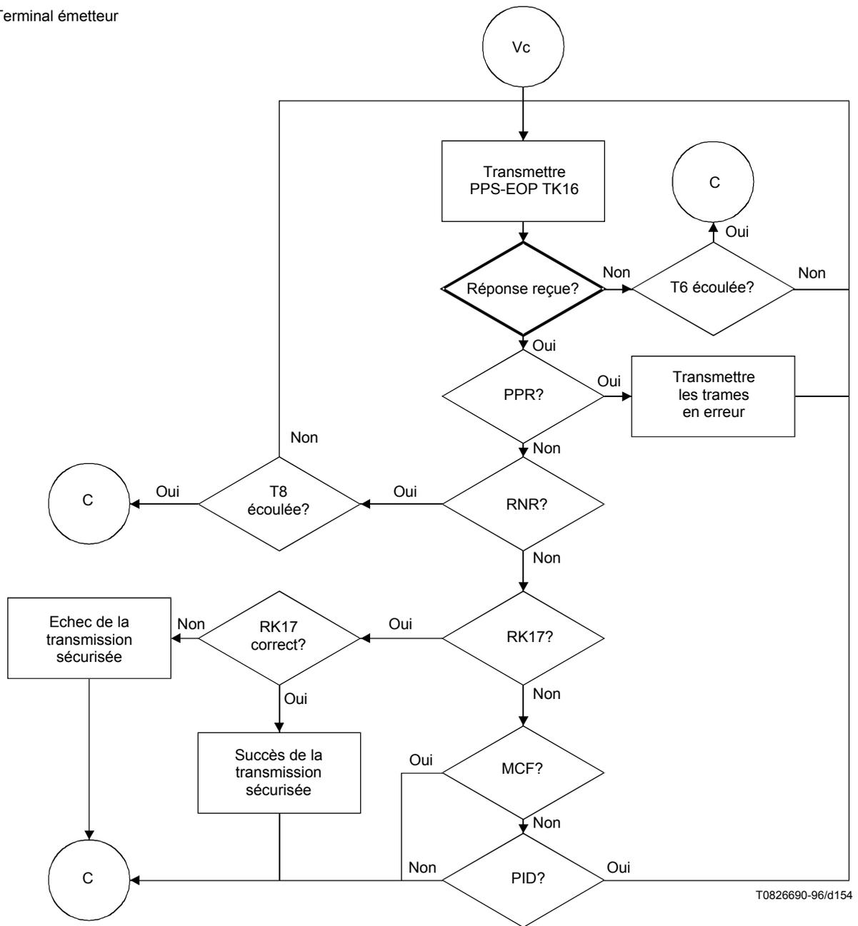
Figure G.8-6/T.30 – Mode duplex (utilisée à la place de la Figure C.18)
