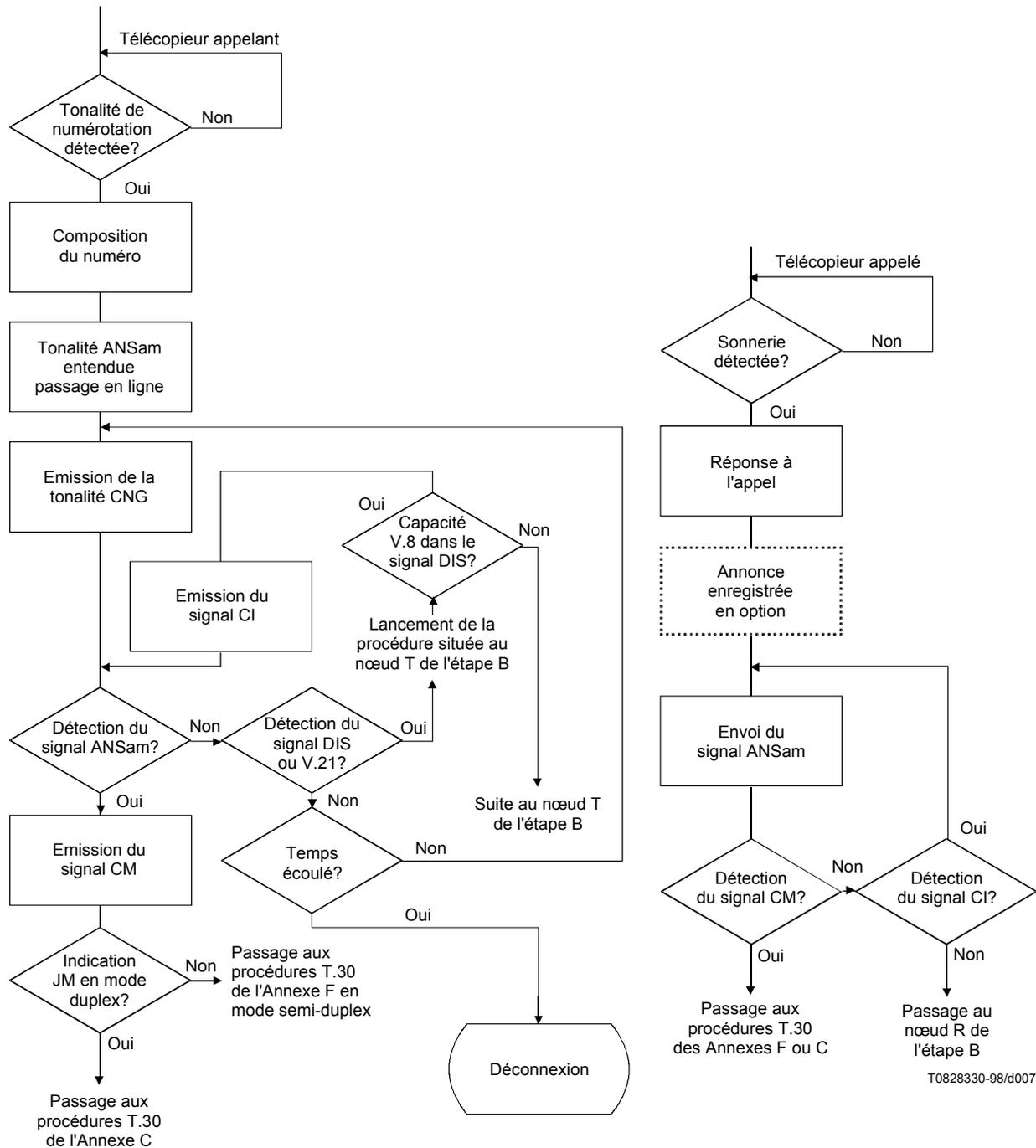
Figure 6b/T.30 – Etablissement de l'appel: méthode de fonctionnement 4 bis b
