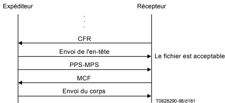
**Figure V.4/T.30 – Fichier transmis acceptable pour un récepteur**
