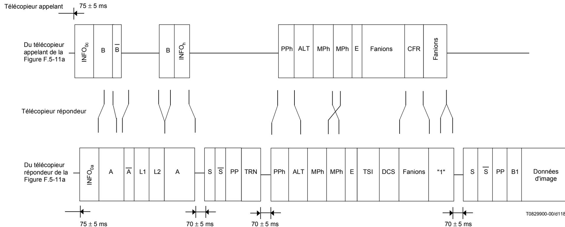
**Figure F.5-11b/T.30 – Relève successive à une émission (passage du mode émission au mode relève dans le terminal appelant [2/2])**
