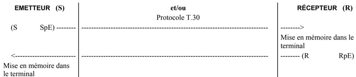
**Figure H.3/T.30 – Mécanisme du mode enregistrement**
