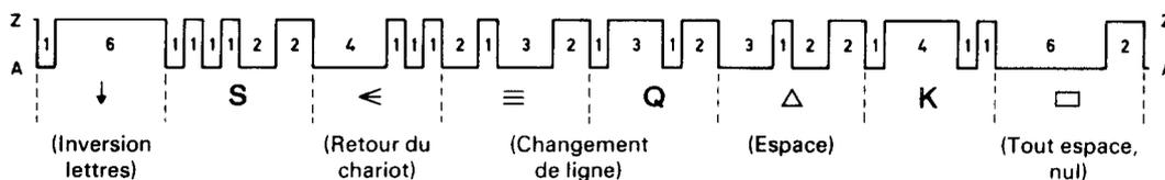
*Remarque* – Les longueurs des éléments d'arrêt des caractères sont alternativement d'une durée de un et deux intervalles unitaires.
