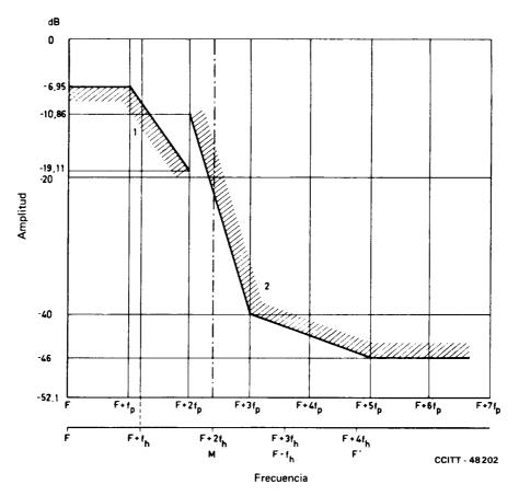
F = frecuencia portadora de un canal  $f_p$  = frecuencia de modulación = 100 Hz  $f_h$  = desplazamiento de frecuencia = 120 Hz
