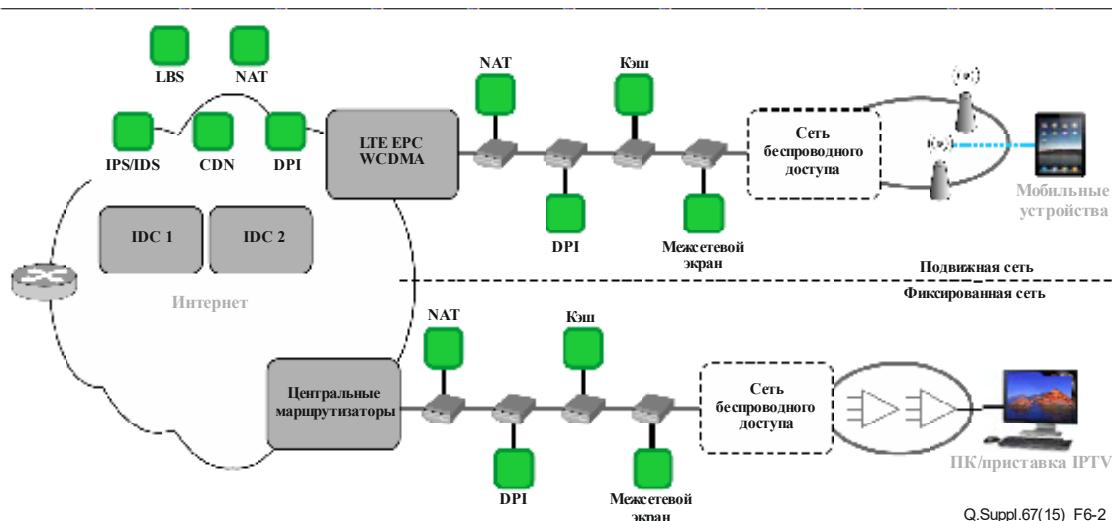
**Рисунок 6-2 – Промежуточные узлы в фиксированной и подвижной сетях**
