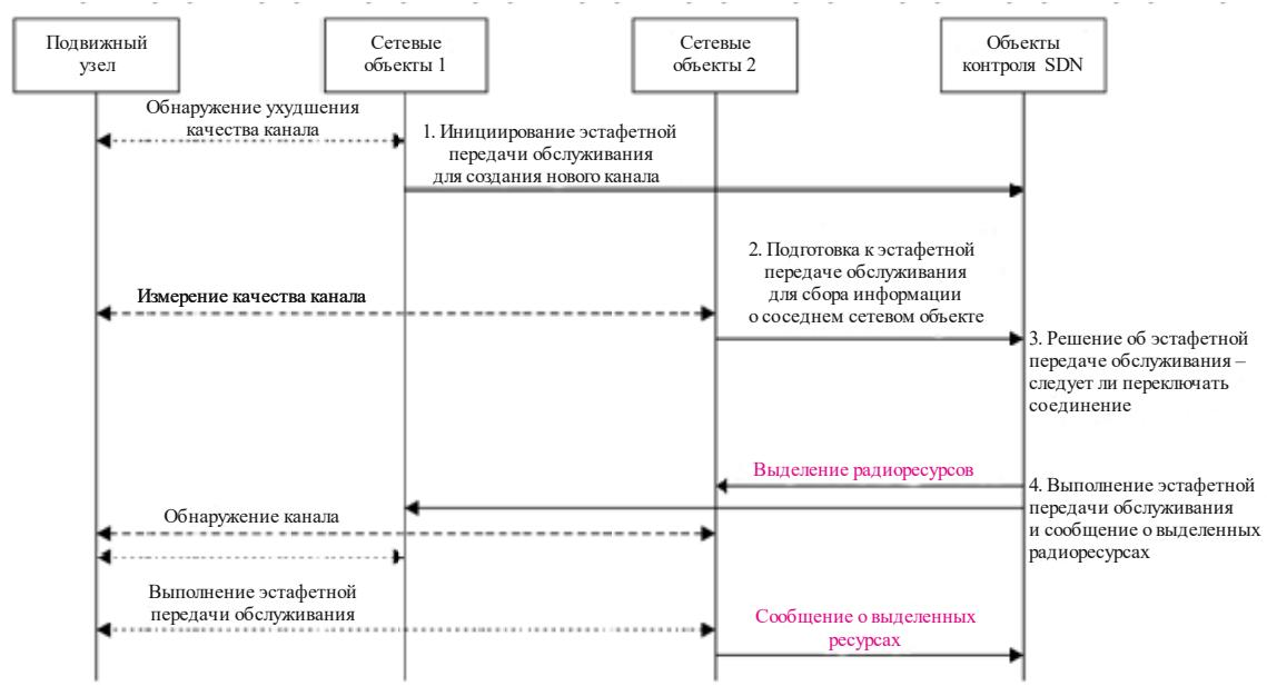
Рисунок I.1 – Бесшовная эстафетная передача обслуживания в процедурах SDMN
