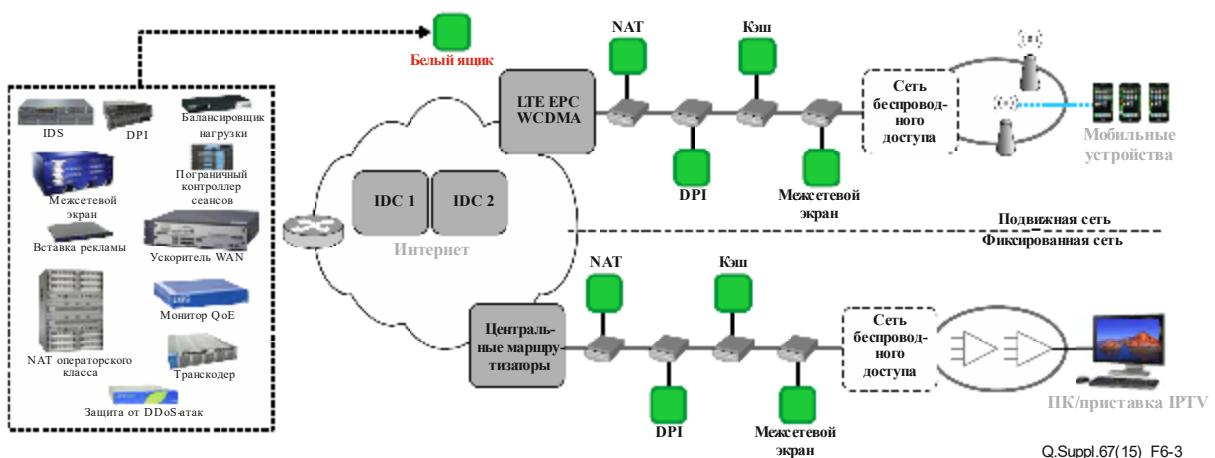
Рисунок 6-3 – Белые ящики в фиксированной и подвижной сетях
