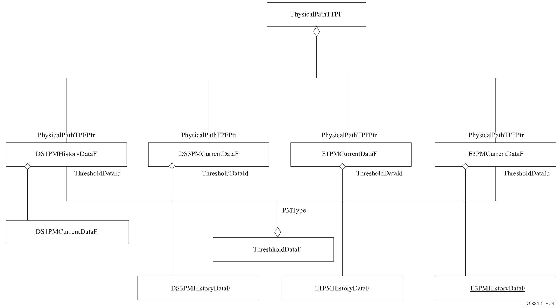
**Рисунок C.4/Q.834.1 – Е-Р диаграмма монитора физических характеристик**
