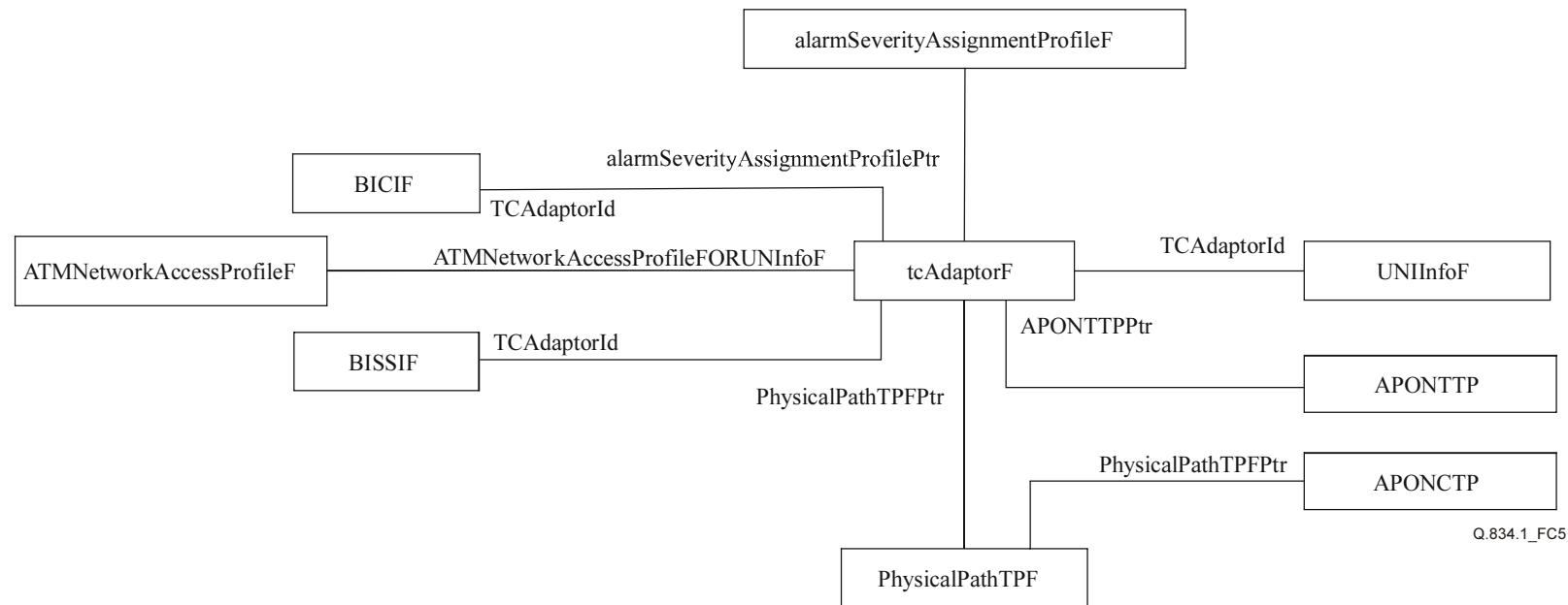
Рисунок C.5/Q.834.1 – E-R диаграмма адаптера ТС
