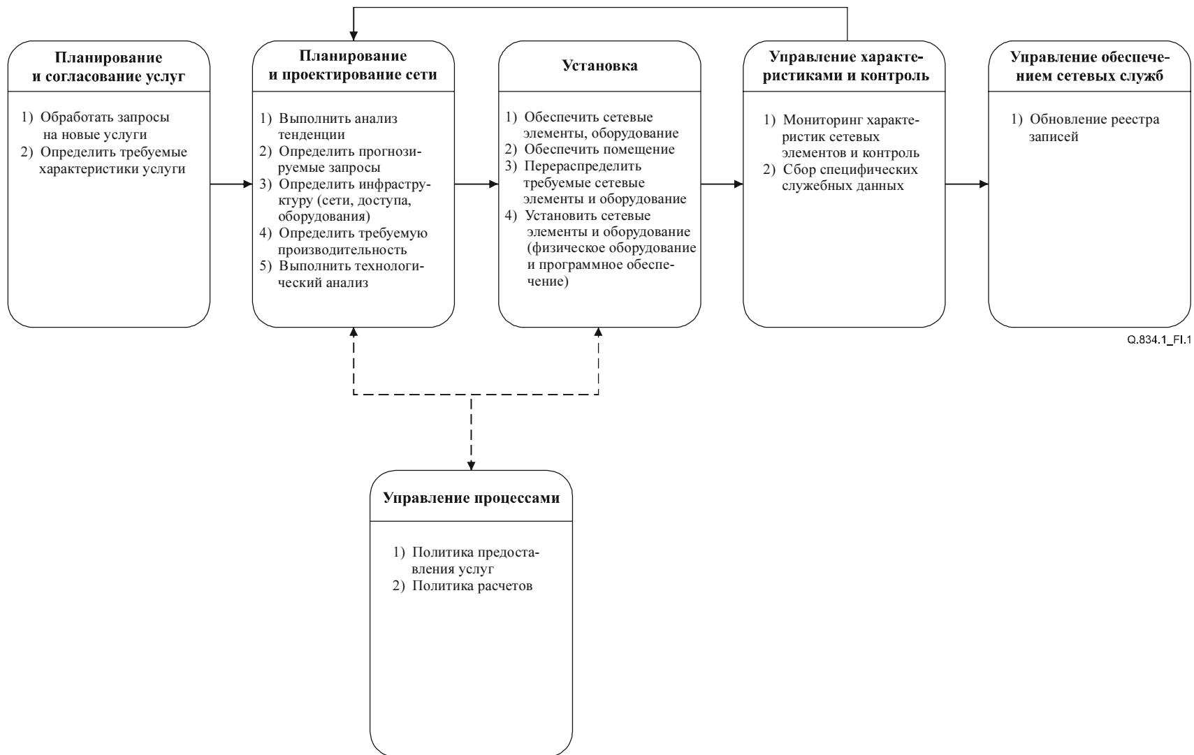
Рисунок I.1/Q.834.1 – Процесс планирования и проектирования высокого уровня
