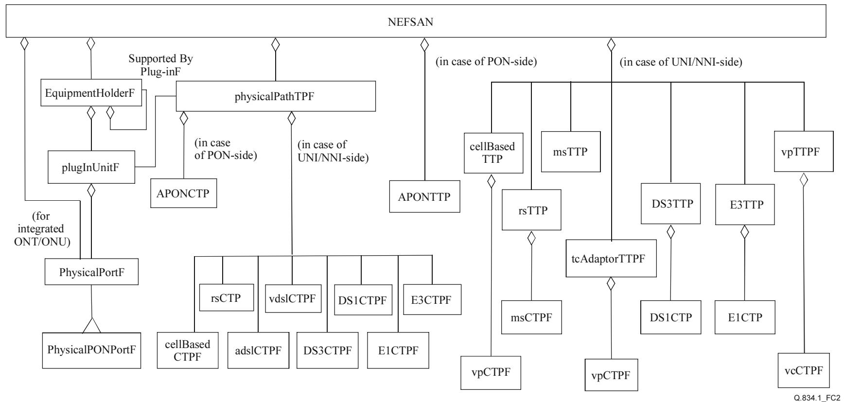
**Рисунок С.2/Q.834.1 – Е-Р диаграмма пунктов окончаний (с точки зрения сетевого элемента NE)**
