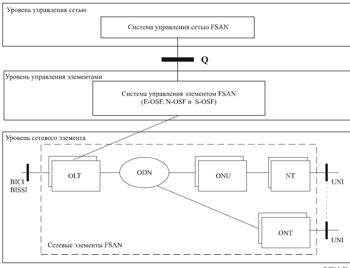
**Рисунок 1/Q.834.1 – Сетевые элементы FSAN и рабочий интерфейс архитектуры функционирования**
