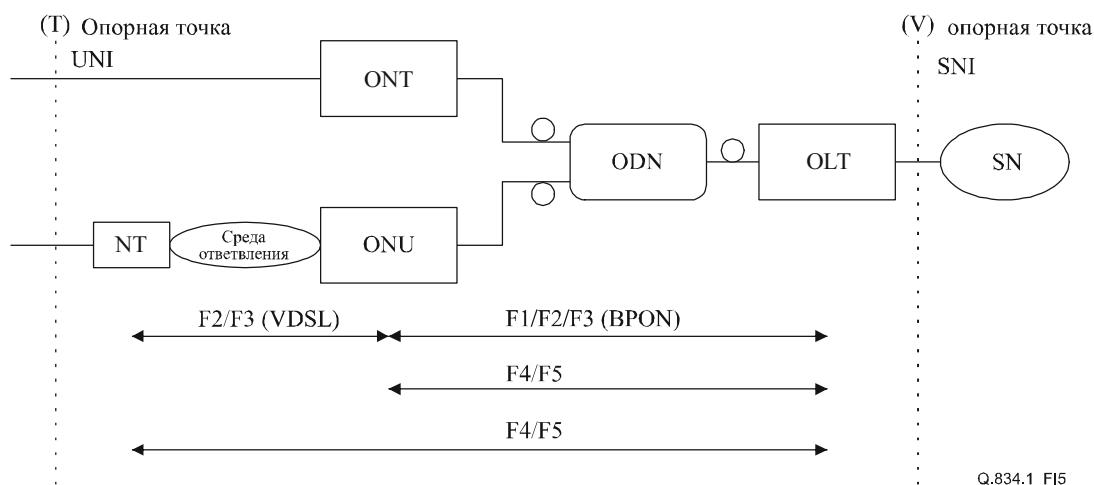
**Рисунок I.5/Q.834.1 – Потоки ОАМ FSAN**
