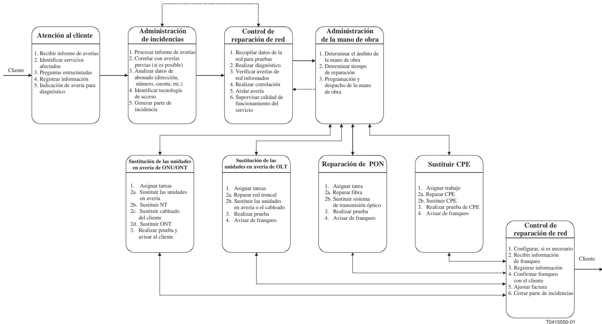
Figura I.3/Q.834.1 – Proceso de alto nivel de la reparación
