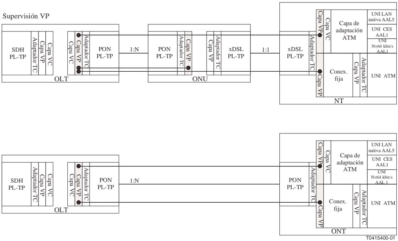
Figura 4/Q.834.1 – Supervisión de la calidad de funcionamiento en la capa VP
