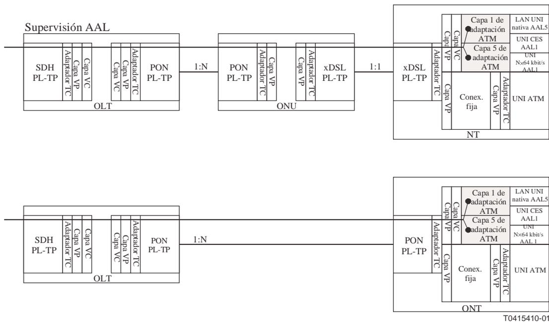
**Figura 6/Q.834.1 – Supervisión de la calidad de funcionamiento en la AAL**
