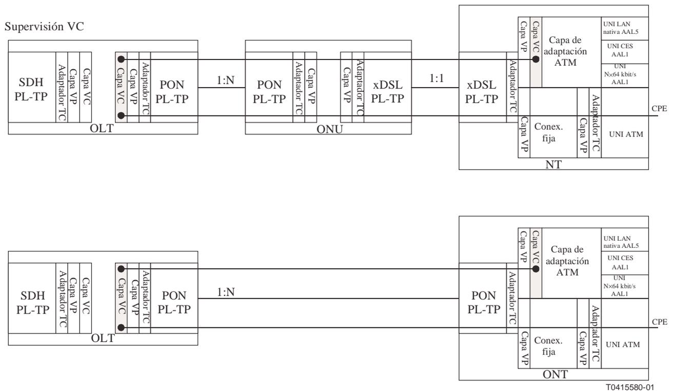
Figura 5/Q.834.1 – Supervisión de la calidad de funcionamiento en la capa VC
