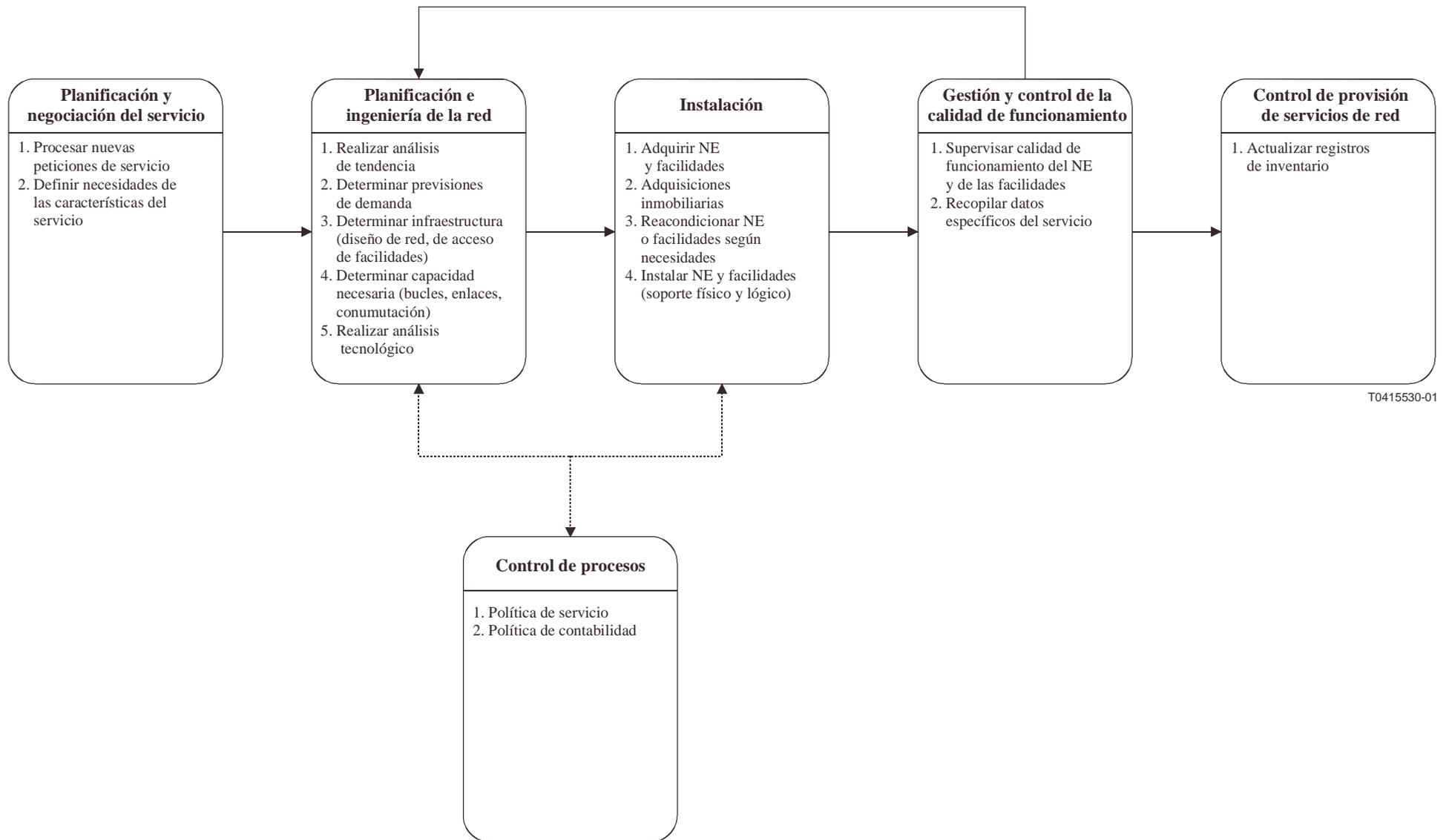
**Figura I.1/Q.834.1 – Procesos de ingeniería y de planificación de alto nivel**
