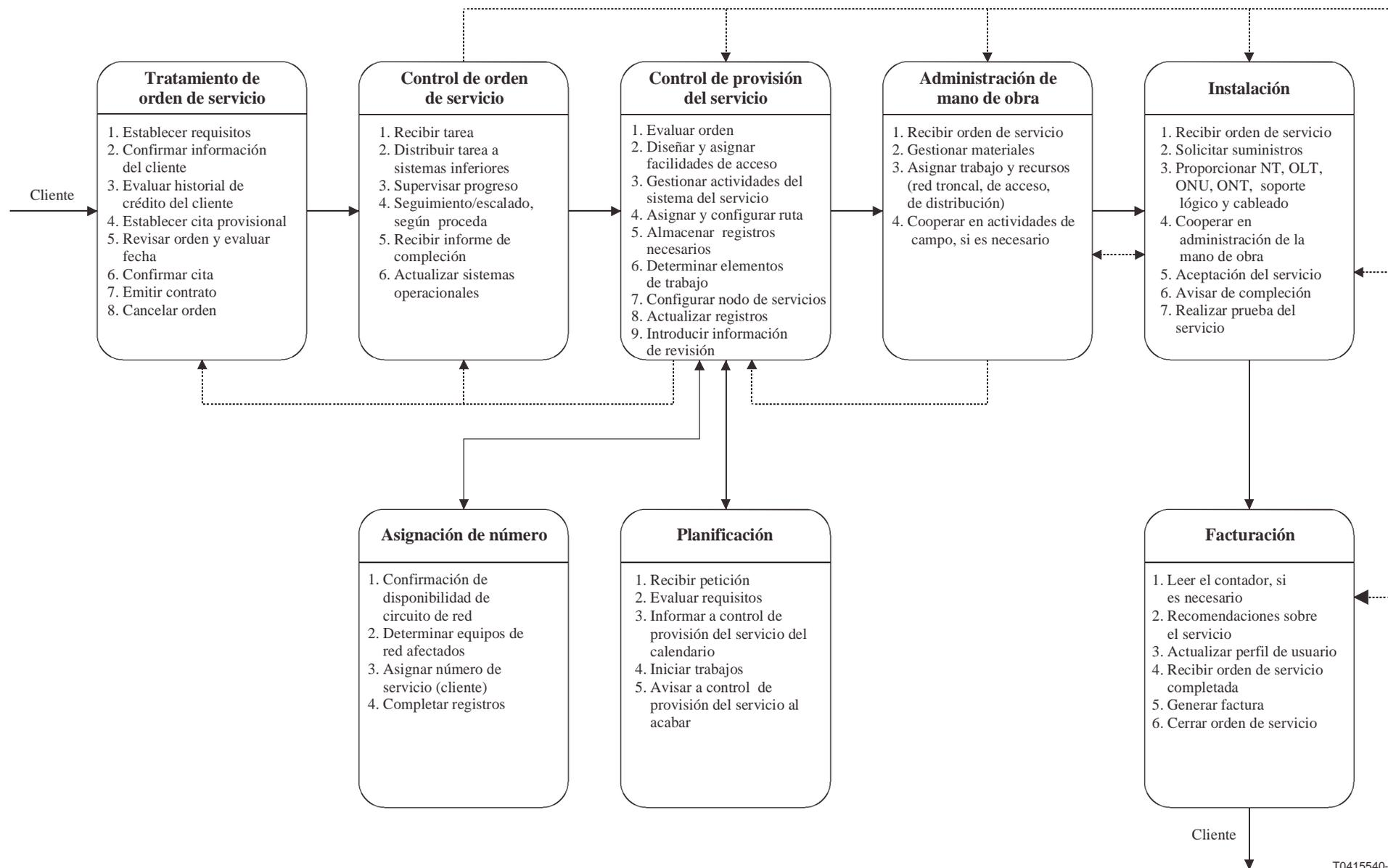
Figura I.2/Q.834.1 – Proceso de alto nivel de provisión del servicio
