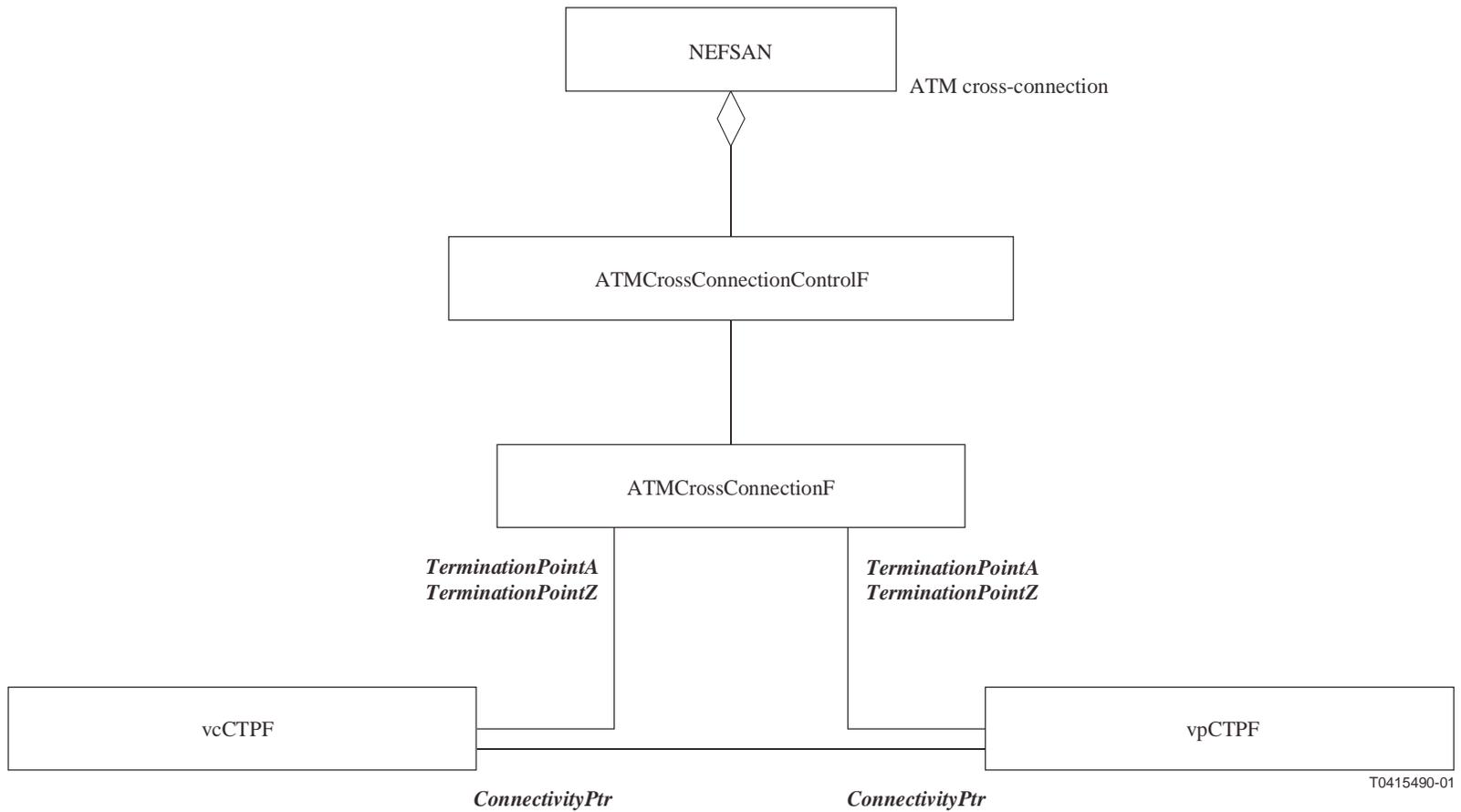
Figura C.6/Q.834.1 – Diagrama E-R para la conexión cruzada
