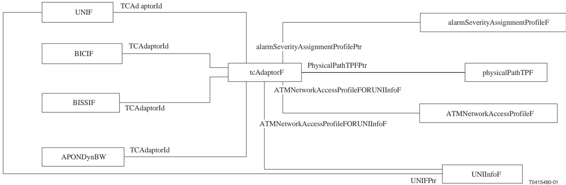
Figura C.5/Q.834.1 – Diagrama E-R para el TCAdaptor
