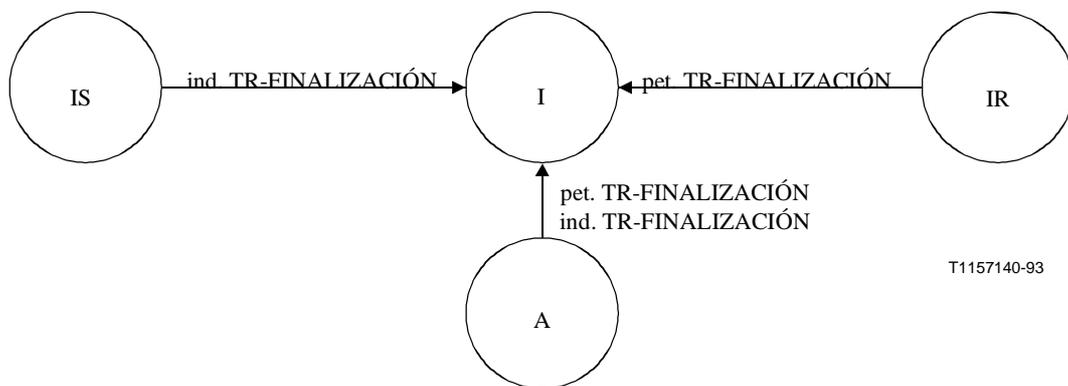
**Figura 9/Q.771 – Transiciones de estado para la finalización básica de una transacción**
