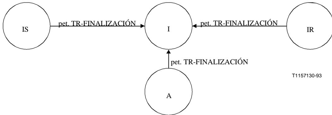
**Figura 8/Q.771 – Transiciones de estado para la finalización preconvencida de transacción**
