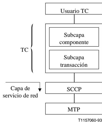
Figura 1/Q.771 – Estructura de la TC dentro del sistema de señalización N.º 7
