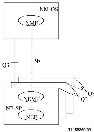
**Figure 2/Q.750 (feuillet 1 de 3) – Exemple de réalisation physique pour la gestion du SS n° 7**
