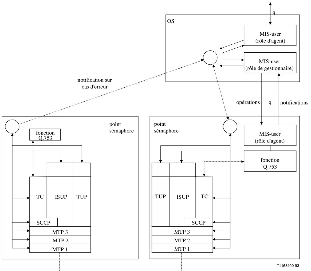
Figure 4/Q.750 – Objets gérés utilisant la communication interne
