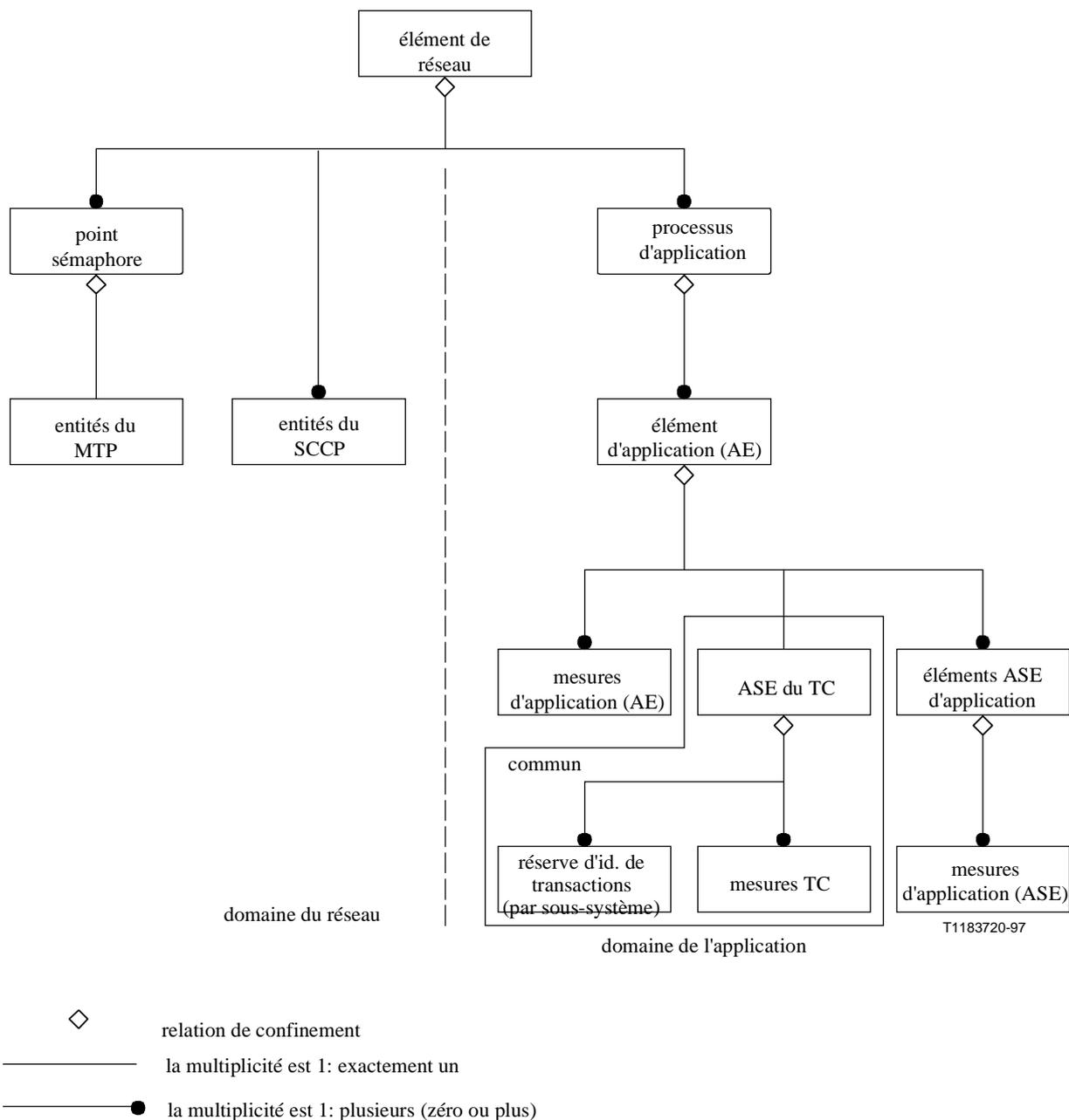
NOTE 1 – Cette figure représente une possibilité de relation de dénomination entre classes d'objets gérés. La relation entre instances d'objets gérés en un point sémaphore relève de l'implémentation.
