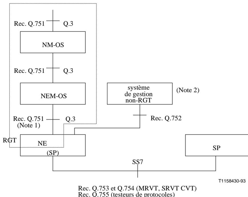
NM-OS système d'exploitation pour la gestion de réseau (OS)
