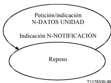
**Figura 9/Q.711 – Diagrama de transición de estados para una secuencia de primitivas de servicio sin conexión en un punto de acceso a servicio SCCP**
