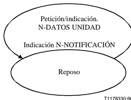
**Figura 9/Q.711 – Diagrama de transición de estados para una secuencia de primitivas de servicio sin conexión en un punto de acceso a servicio SCCP**
