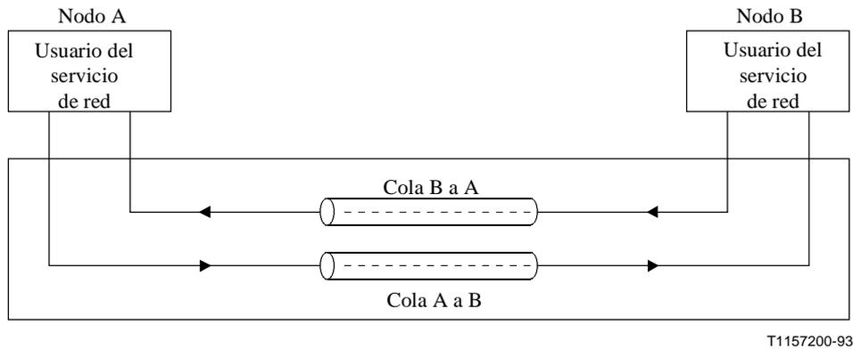
**Figura 4/Q.711 – Modelo para la comunicación entre nodos dentro de la SCCP (servicio con conexión)**
