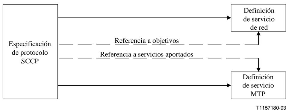
**Figura 2/Q.711 – Relación entre la especificación de protocolo SCCP y la definición de servicios adyacentes**
