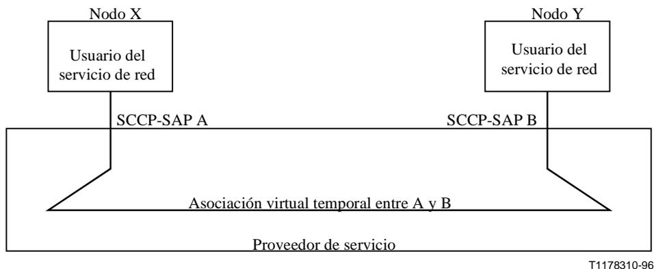
**Figura 5/Q.711 – Modelo de la transmisión en un servicio de red sin conexión**
