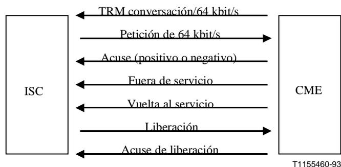
**Figura 5/Q.50 – Flujos de información típicos entre el centro de conmutación internacional y el equipo de multiplicación de circuitos**
