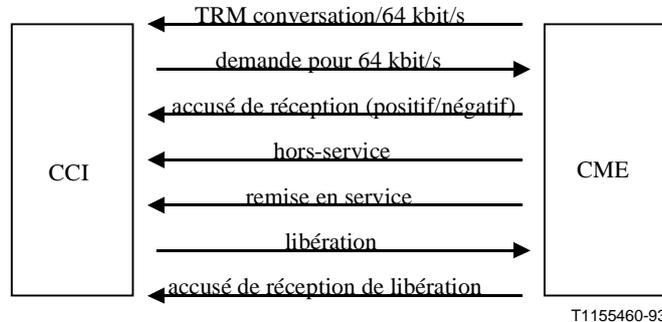
**Figure 5/Q.50 – Flux d'information types entre le centre de commutation international et l'équipement de multiplication de circuits**
