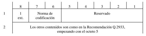
Figura 3/Q.2727 – Campo de parámetro parámetros de núcleo de la capa de enlace
