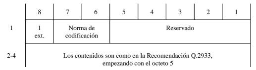
Figura 2/Q.2727 – Campo del parámetro capacidad portadora en banda ancha
