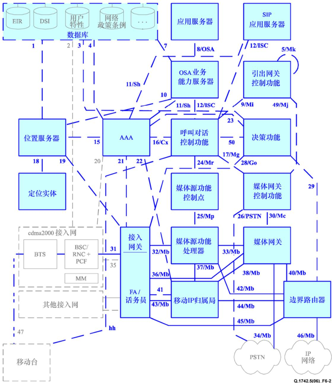
注 - “IP MMD核心网”由加重（实线及点划线）和带阴影的方框（电子版中是蓝色的）表示的网络单元和参考点未标识。
