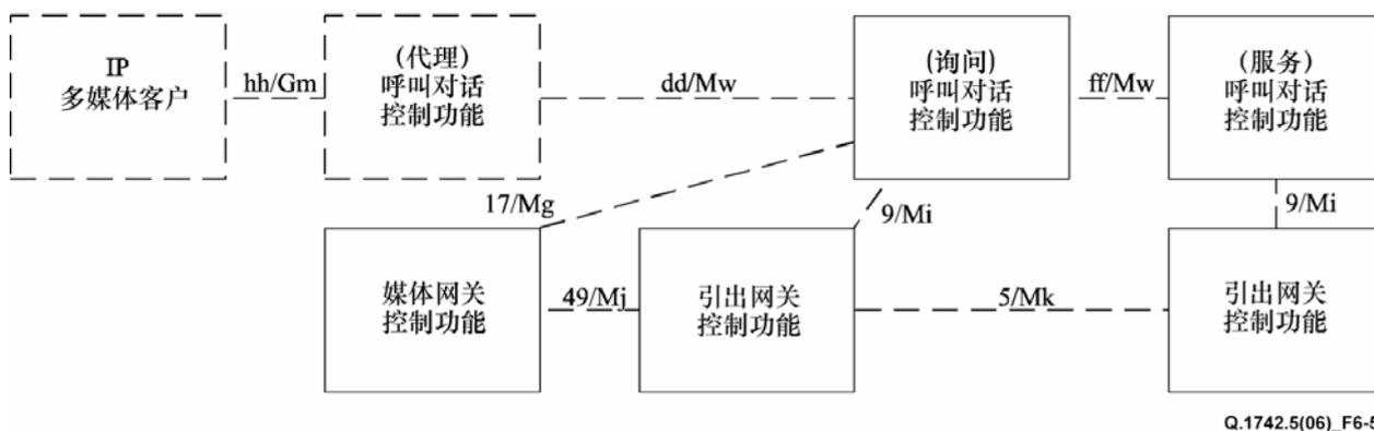
图 6-5/Q.1742.5—对话控制参考模型
