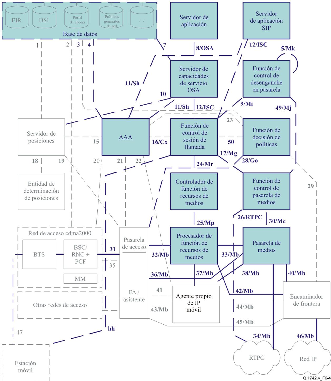
NOTA – El "subsistema de sesión multimedia" viene identificado por los puntos de referencia y elementos de red indicados en negrita (ya sea con líneas continuas o de puntos) y con casillas sombreadas (de color azul en la versión electrónica).
