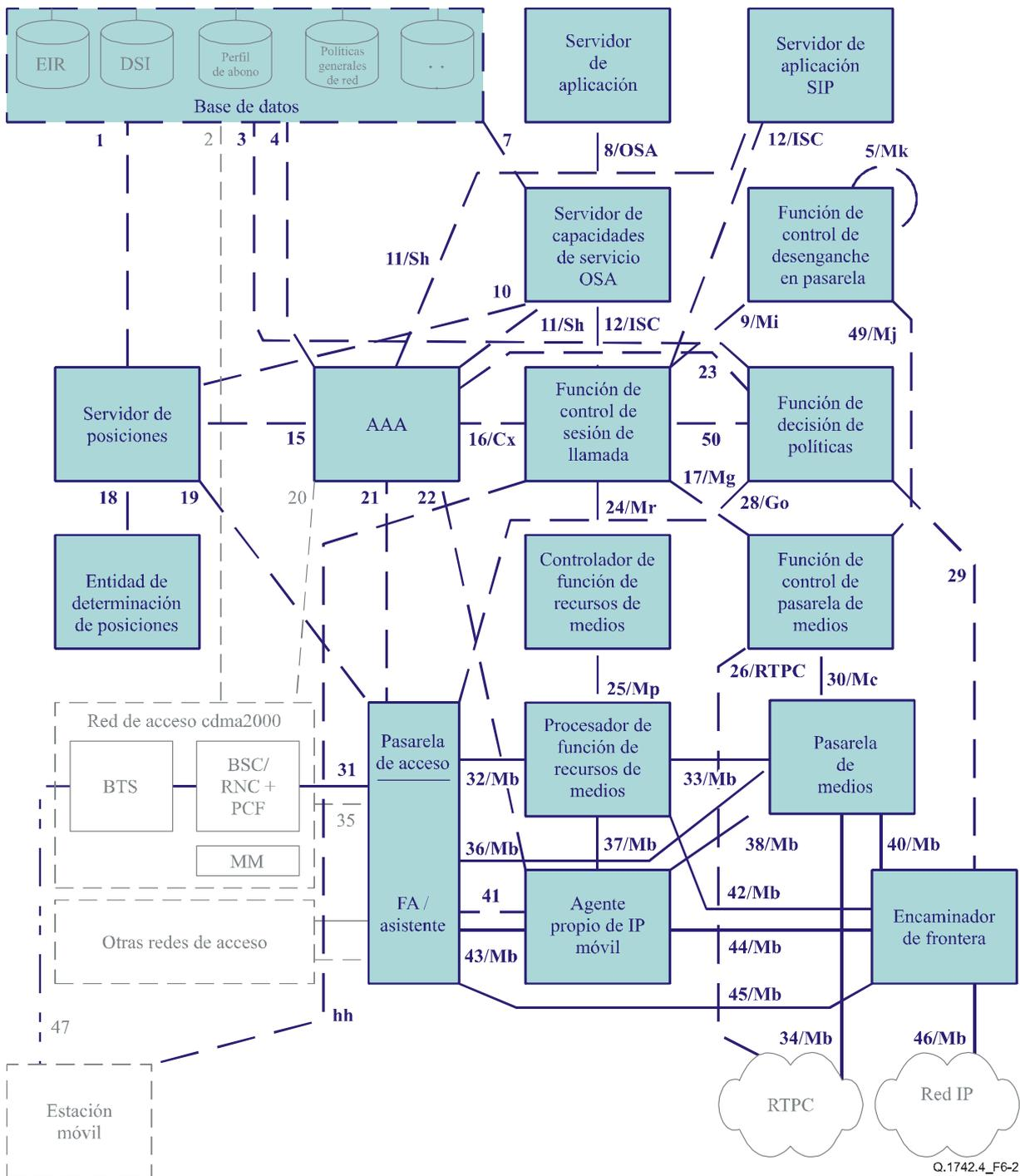
NOTA – La "red medular MMD IP" viene identificada por los puntos de referencia y elementos de red indicados en negrita (ya sea con líneas continuas o de puntos) y con casillas sombreadas (de color azul en la versión electrónica).
