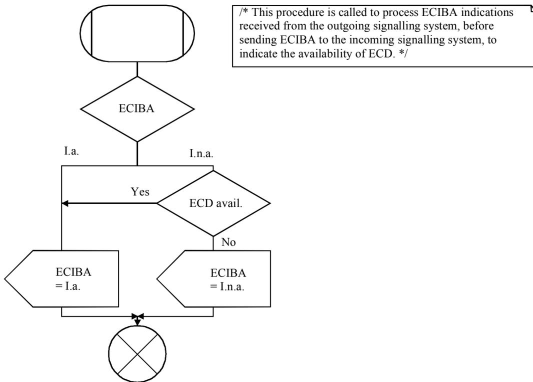
Figure A.14/Q.115 – Procédure de limitation d'écho pour information additionnelle ECIBA
