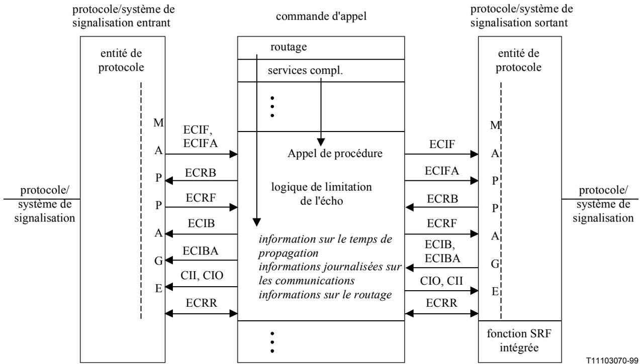
**Figure A.1/Q.115 – Commutateur de type 1**
