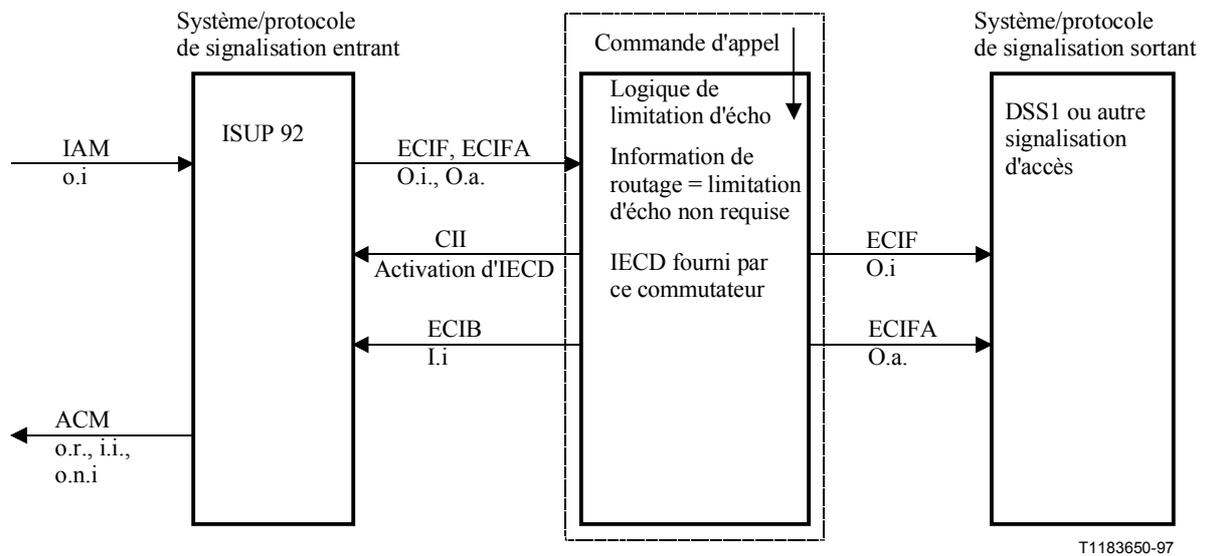
**Figure I.2/Q.115 – Interactions entre logique de limitation d'écho et ISUP'92 (se référer au commutateur 6 dans la Figure C.1/Q.764, 1993)**
