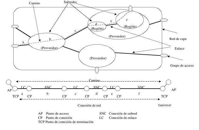
Figura 3/M.3208.1 – Circuitos arrendados – Visión de la topología de los recursos de telecomunicación
