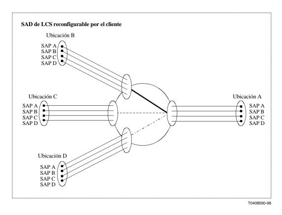
Figura 6/M.3208.1 – Ejemplo de topología del servicio de circuitos arrendados reconfigurable
