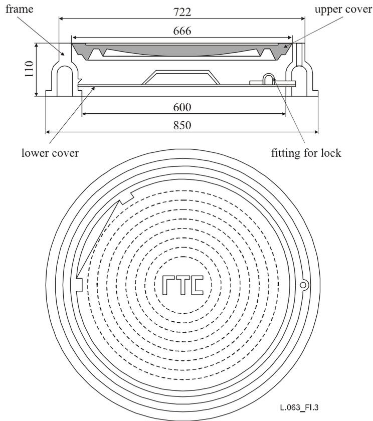
**Figure I.3 – Cast hatch**
