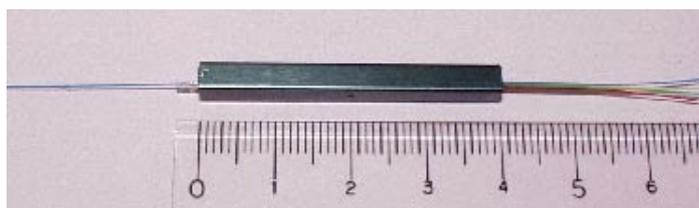
**Figura I.2/L.52 – Fotografía de un prototipo de componente de derivación (fibra óptica)**
