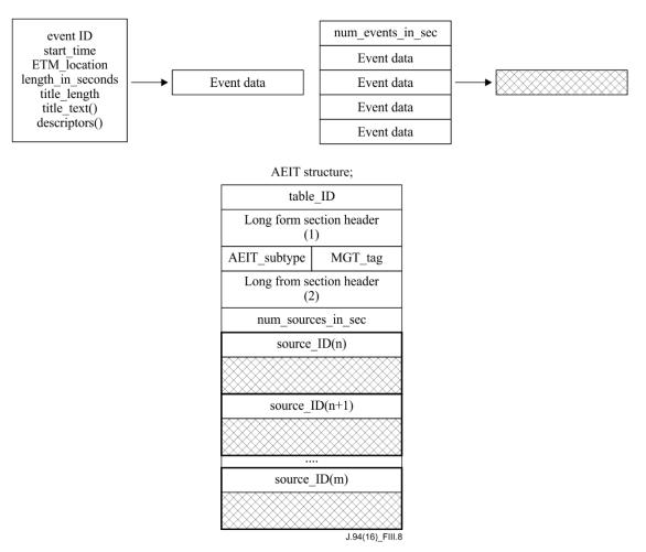
Figure III.8 – AEIT data structure
