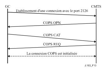
Figure 13/J.163 – Etablissement d'une connexion COPS
