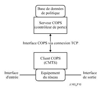
Figure 10/J.163 – Disposition du contrôle d'admission de la QS
