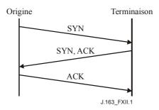
Figure XII.1/J.163 – Etablissement de la connexion TCP
