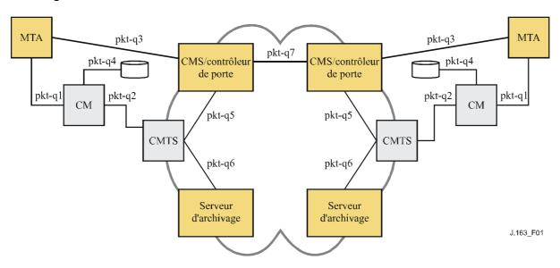
Figure 1/J.163 – Interfaces de signalisation de la QS dans le réseau IPCablecom
