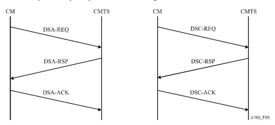
Figure 5/J.163 – Echanges de DSA et DSC entre câblo-modem et CMTS
