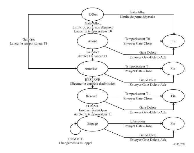
Figure 9/J.163 – Schéma de transition d'états de porte
