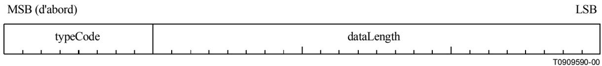
Figure 16/J.151 – Format de sous-trame **Clear\_OSD**
