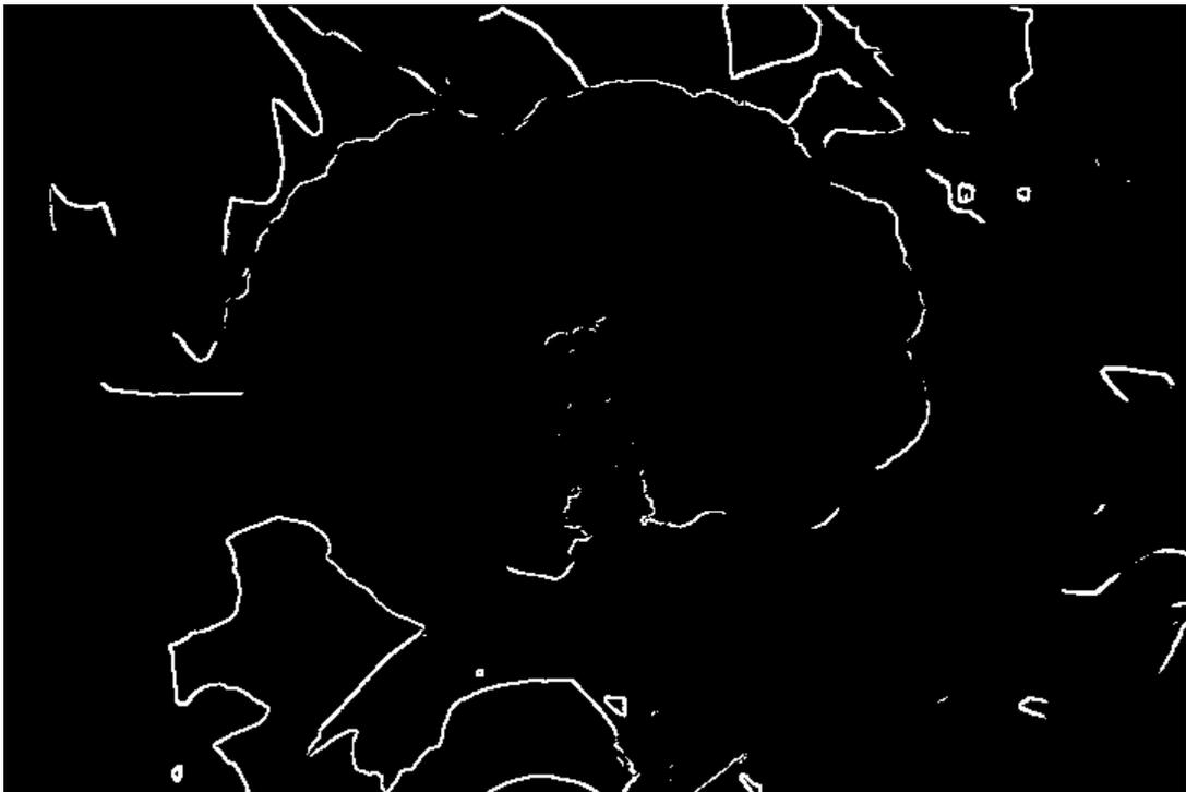
**Figura B.5 – Imagen de bordes binarios (imagen máscara) obtenida por aplicación de umbrales a la imagen de gradiente de magnitud de la Figura B.4**
