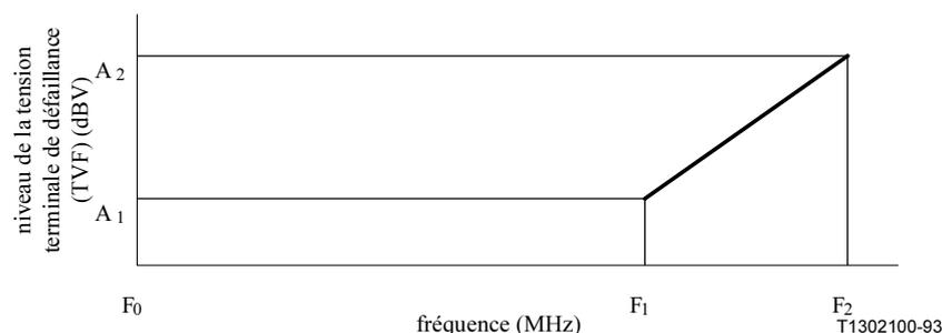
Figure 4/I.432.2 – Réponse en fréquence d'une tension terminale de défaillance
