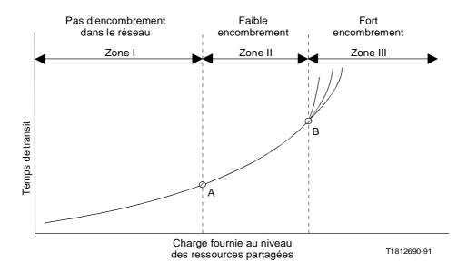
Remarque – Les différentes courbes qui apparaissent dans la zone de fort encombrement indiquent des différences de réaction et de dégradation des réseaux en présence d'un fort encombrement.
