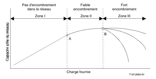
Remarque – Les différentes courbes qui apparaissent dans la zone de fort encombrement indiquent des différences de réaction et de dégradation des réseaux en présence d'un fort encombrement.
