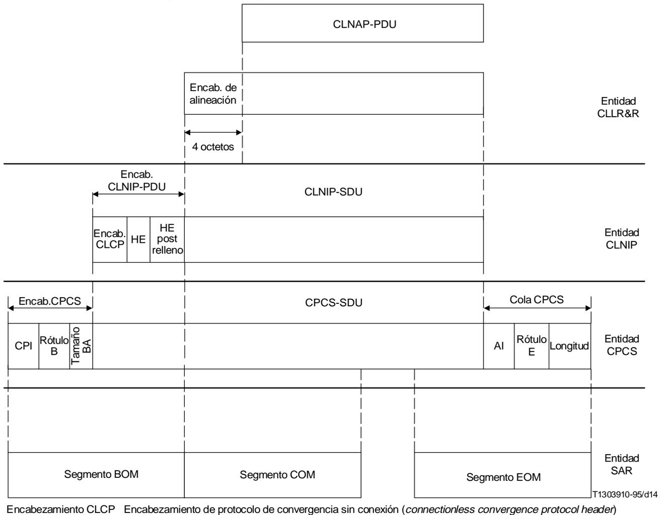
Encabezamiento CLCP Encabezamiento de protocolo de convergencia sin conexión (*connectionless convergence protocol header*)
