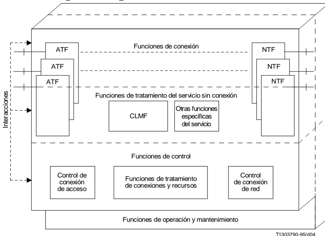
NOTA – Los CLS de tránsito no cumplen funciones de terminación de acceso ni funciones de control de conexión de acceso.
