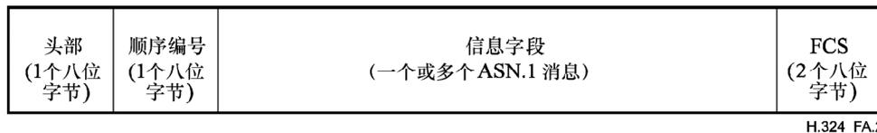
图 A.2/H.324—多媒体系统控制PDU消息的SRP指令帧格式
