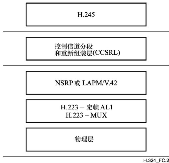
图 C.2/H.324—H.324控制信道协议栈
