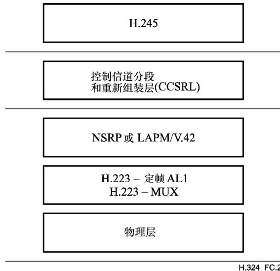
图 C.2/H.324—H.324控制信道协议栈
