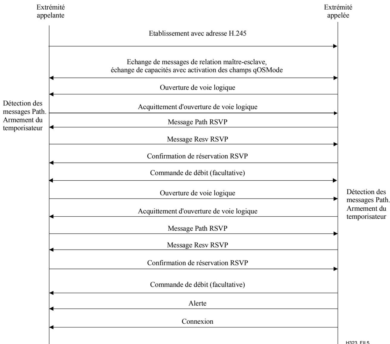
**Figure II.5/H.323 – Synchronisation RSVP sans utilisation de la procédure FastConnect**
