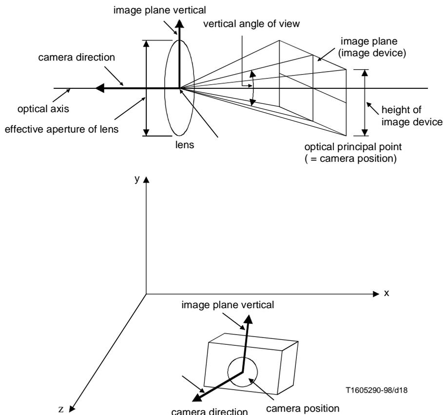
Figure 6-17 -- Camera parameters
