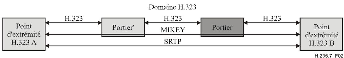
Figure 2/H.235.7 – Scénario de sécurité avec MIKEY et SRTP
