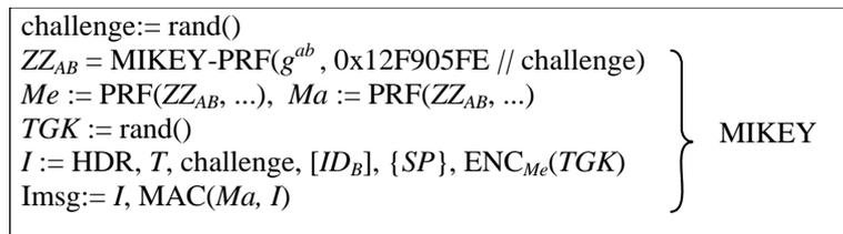
**Figure 5/H.235.7 – Traitement MIKEY-PS par le point d'extrémité B**
