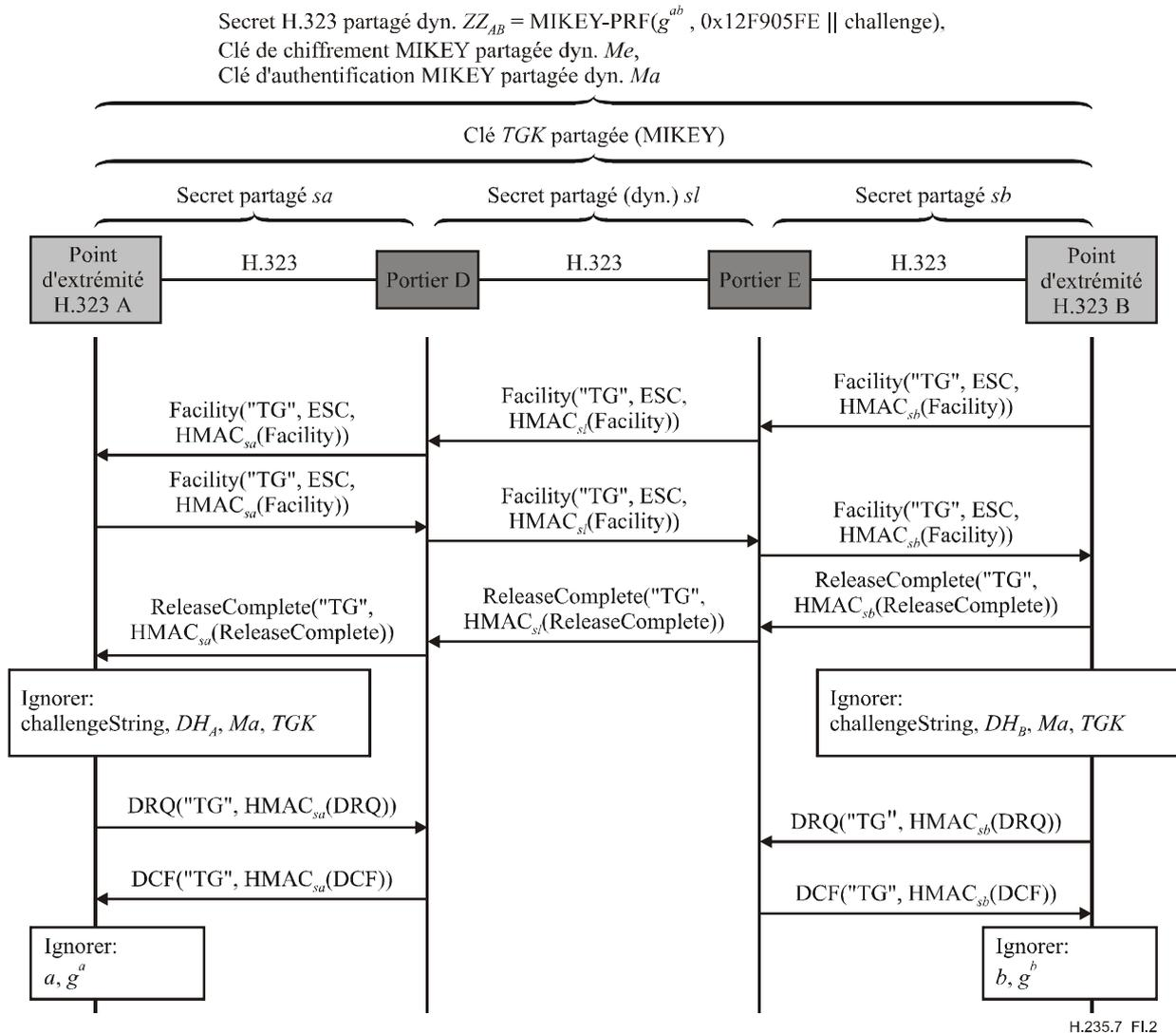
Figure I.2/H.235.7 – Exemple dans lequel le point d'extrémité B termine un appel
