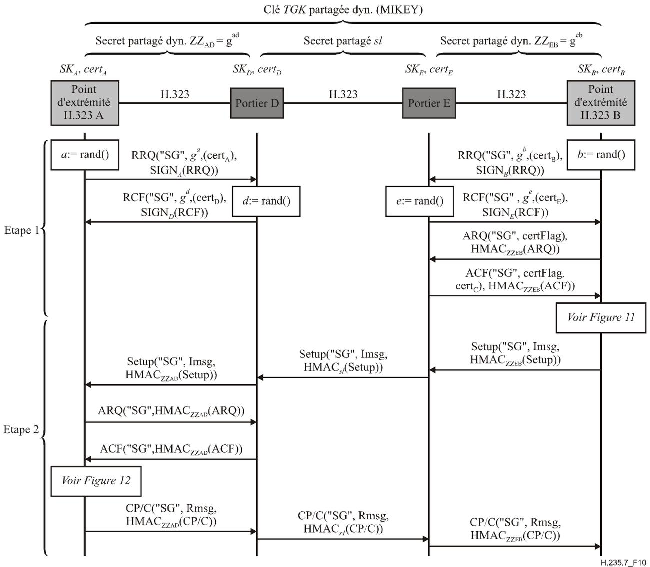
**Figure 10/H.235.7 – Exemple dans lequel le point d'extrémité B appelle le point d'extrémité A (routage par plusieurs portiers) avec MIKEY-PK-SIGN**
