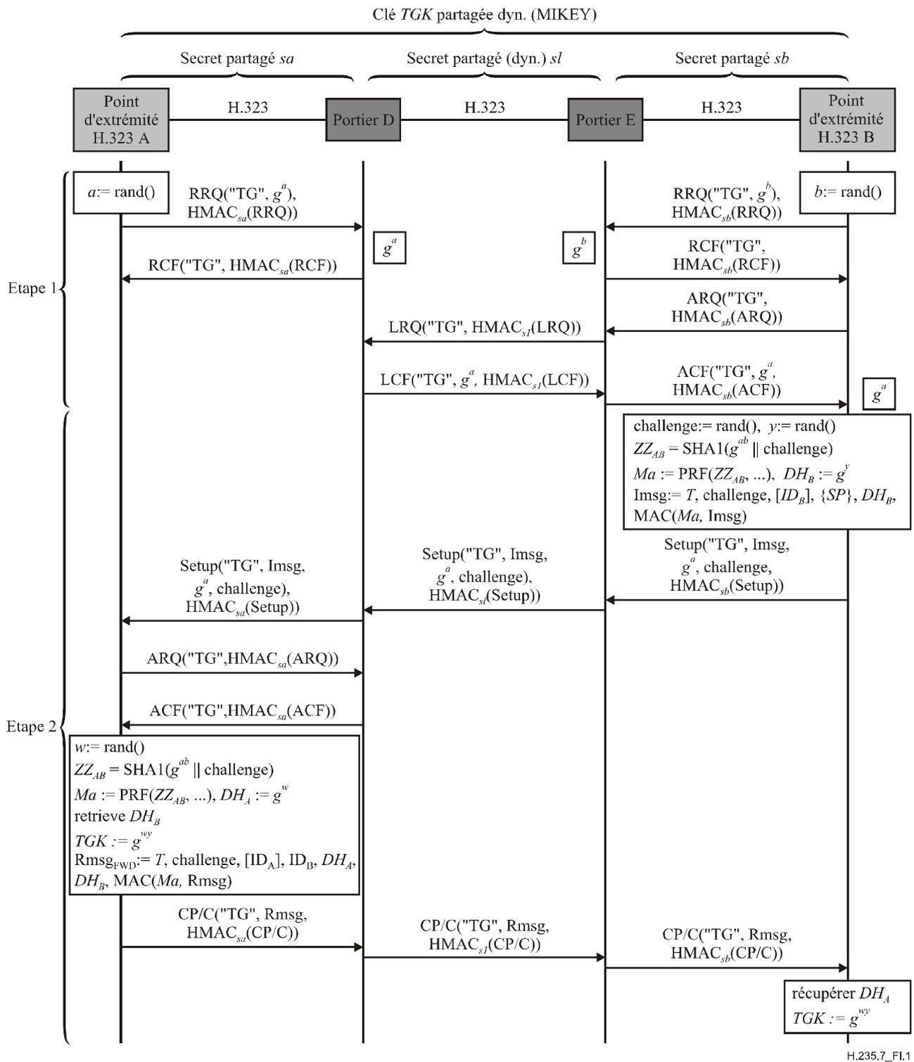
**Figure I.1/H.235.7 – Exemple dans lequel le point d'extrémité B appelle le point d'extrémité A (routage par portiers) avec MIKEY-DHMAC**
