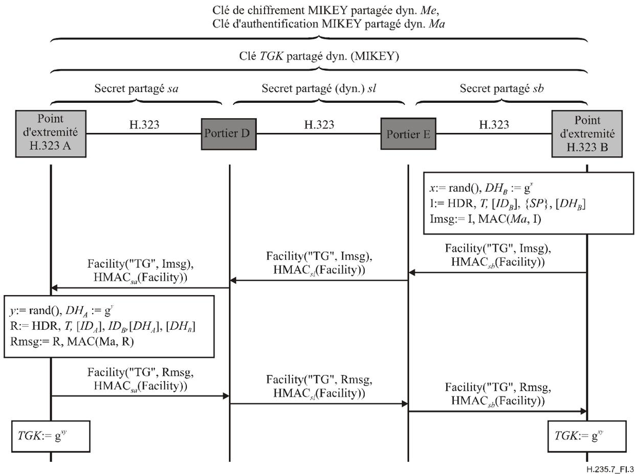
**Figure I.3/H.235.7 – Exemple dans lequel le point d'extrémité B met à jour une clé**
