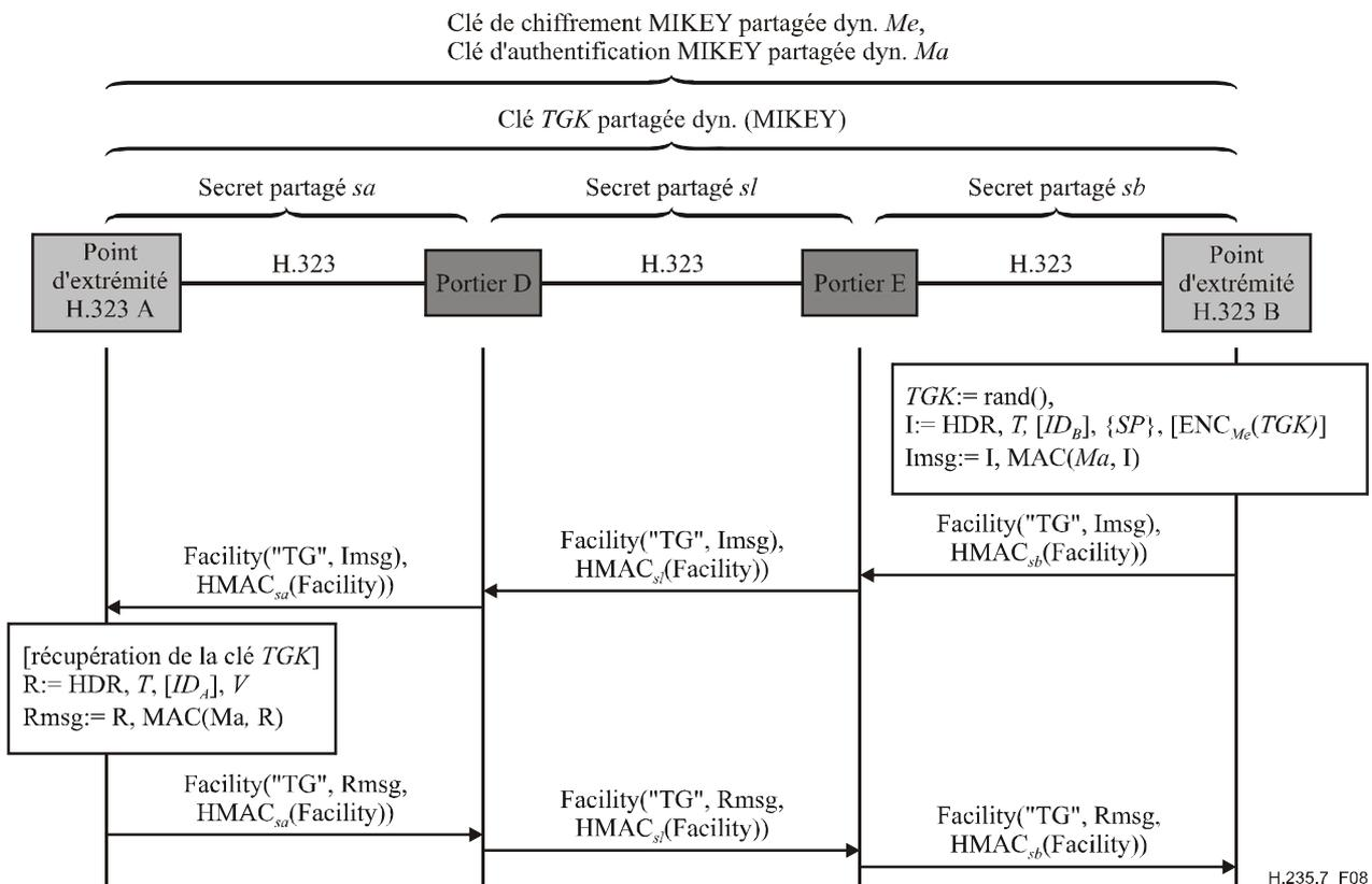
**Figure 8/H.235.7 – Exemple dans lequel le point d'extrémité B met à jour une clé**
