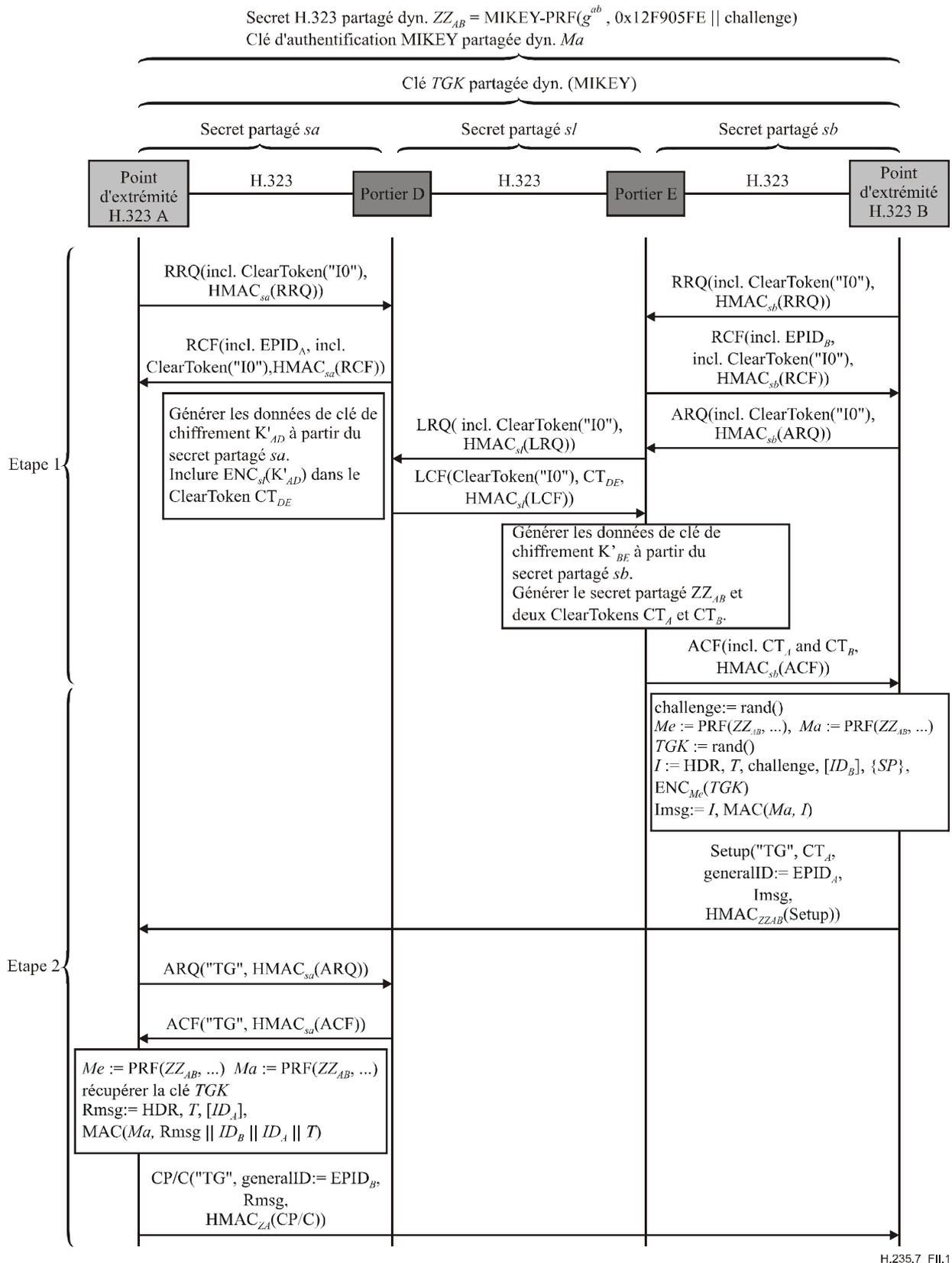
**Figure II.1/H.235.7 – Exemple dans lequel le point d'extrémité B appelle le point d'extrémité A (routage sans portier) avec MIKEY-PS et la procédure DRC1 H.235.4**
