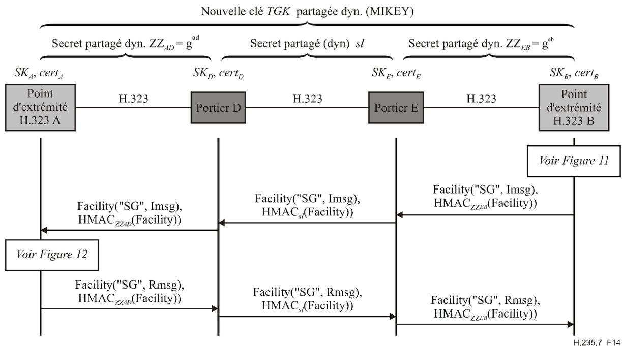
**Figure 14/H.235.7 – Exemple dans lequel le point d'extrémité B (initiateur) lance un recalcul de clé TGK et une mise à jour de lot CSB**
