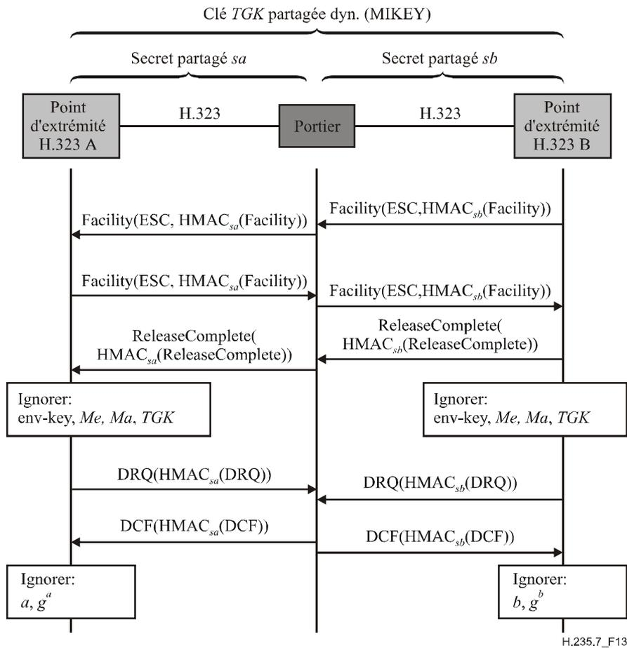
Figure 13/H.235.7 – Exemple dans lequel le point d'extrémité B termine un appel
