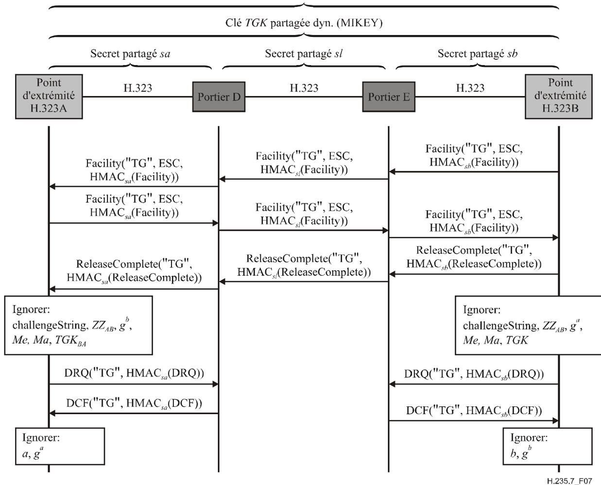
Figure 7/H.235.7 – Exemple dans lequel le point d'extrémité B termine un appel
