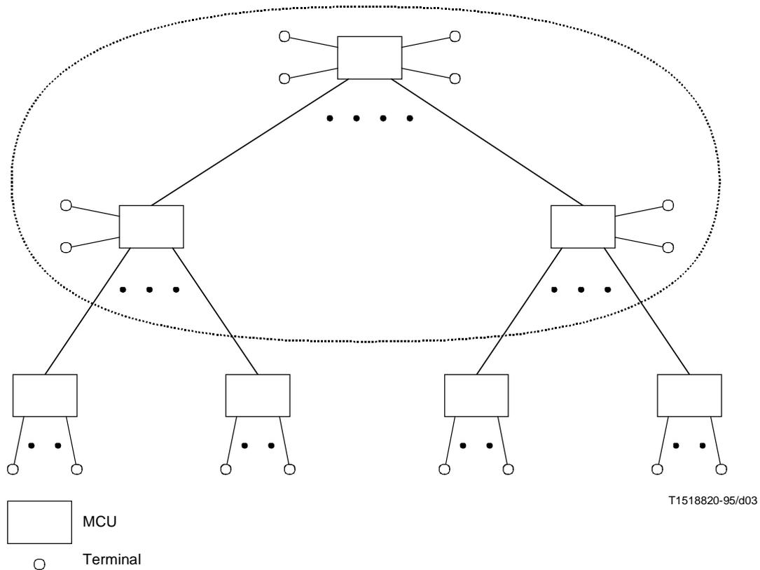
Figura 3/H.231 – Configuración jerárquica de MCU
