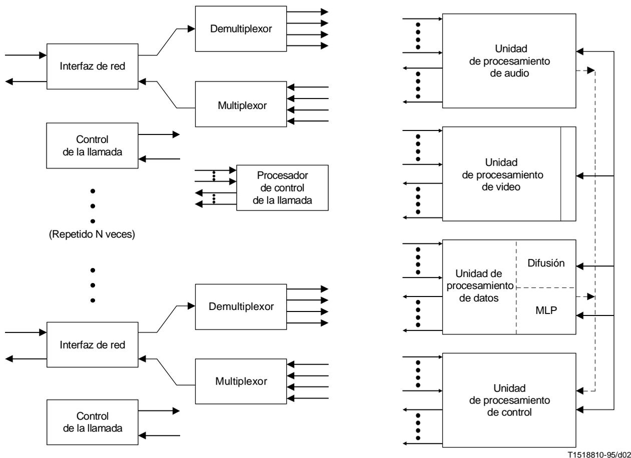
**Figura 2/H.231 – Esquema de unidad de control multipunto**
