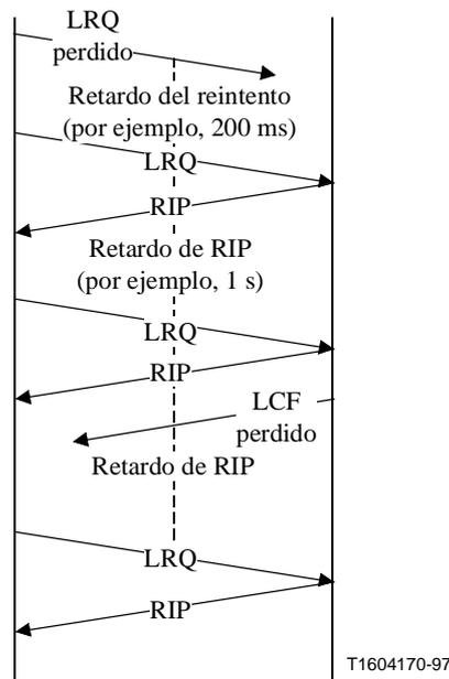
**Figura 2/H.225.0 – Ejemplo de utilización del mensaje RIP**
