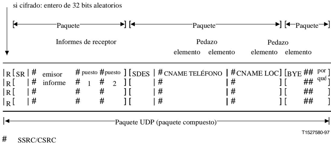
**Figura A.1/H.225.0 – Ejemplo de un paquete compuesto RTCP**
