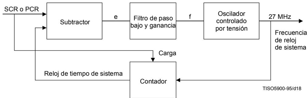
**Figura D.2 – Recuperación del STC mediante un bucle enganchado en fase (PLL)**
