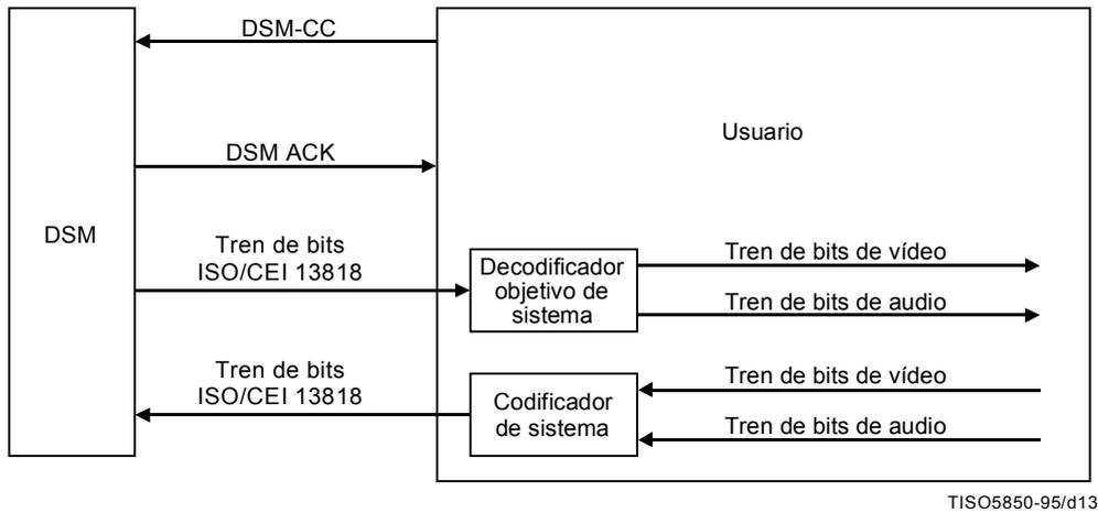
Figura B.1 – Configuración de una aplicación DSM-CC
