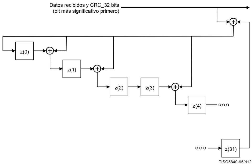
Figura A.1 – Modelo de decodificador CRC de 32 bits
