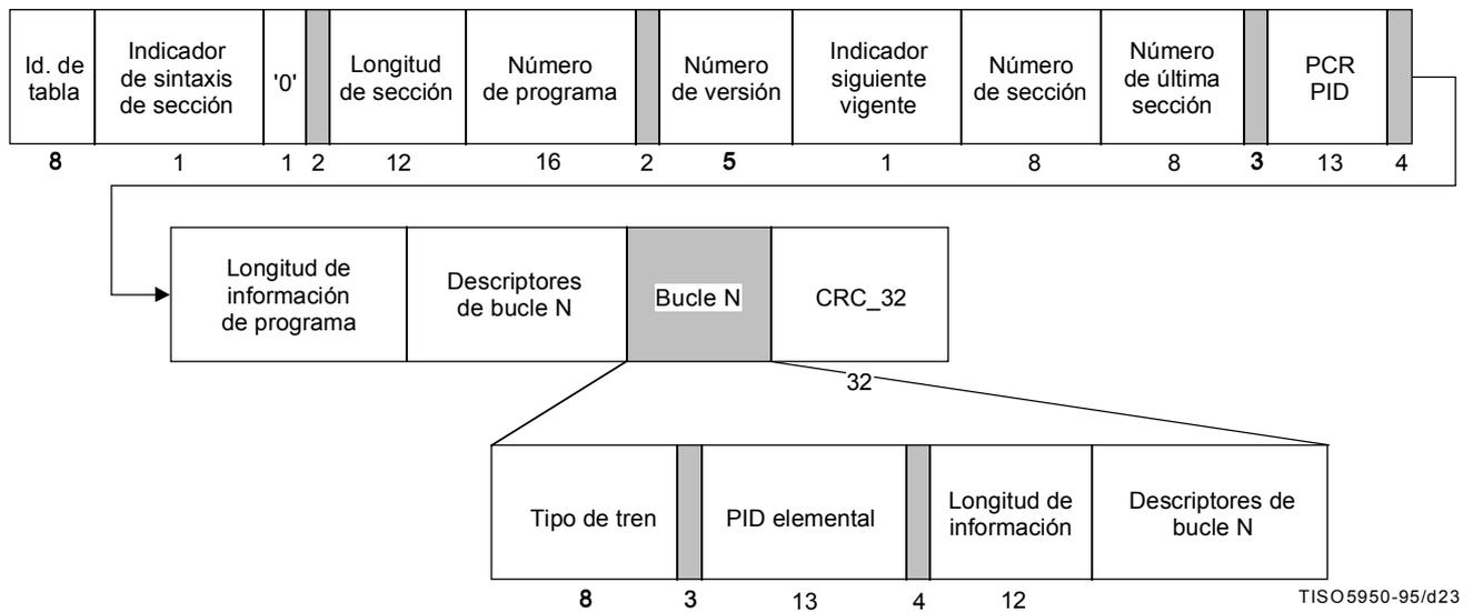
**Figura F.5 – Diagrama de sección de correspondencia de programas de tren de transporte**
