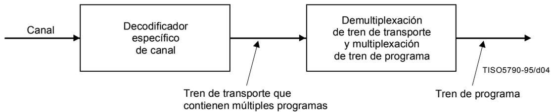
**Figura Intro. 4 – Prototipo de conversión de tren de transporte a tren de programa**
