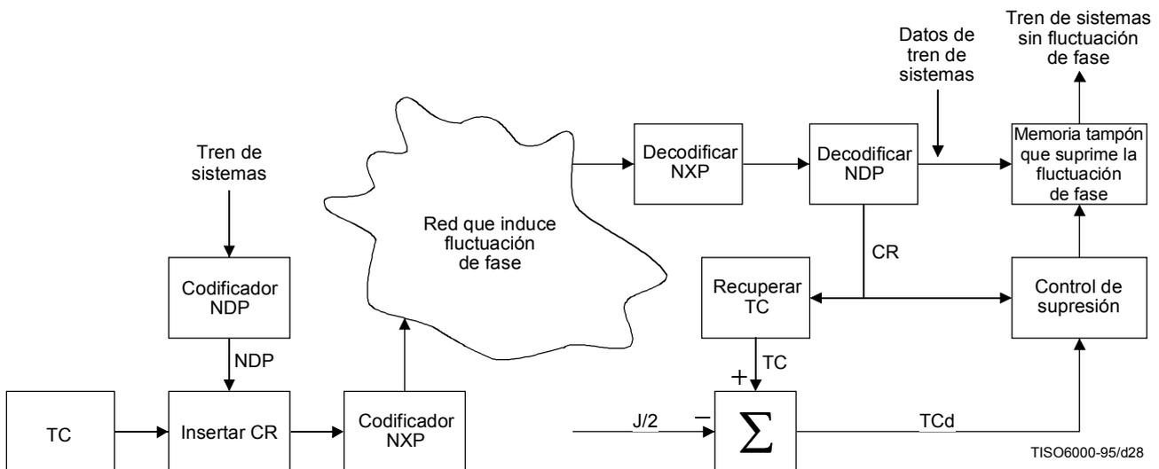
Figura J.2 – Supresión de fluctuación de fase mediante indicaciones de tiempo de la capa de red
