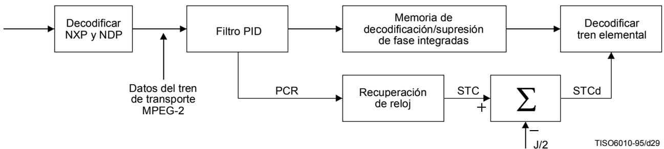
Figura J.3 – Supresión de fluctuación de fase y decodificación MPEG-2 integradas
