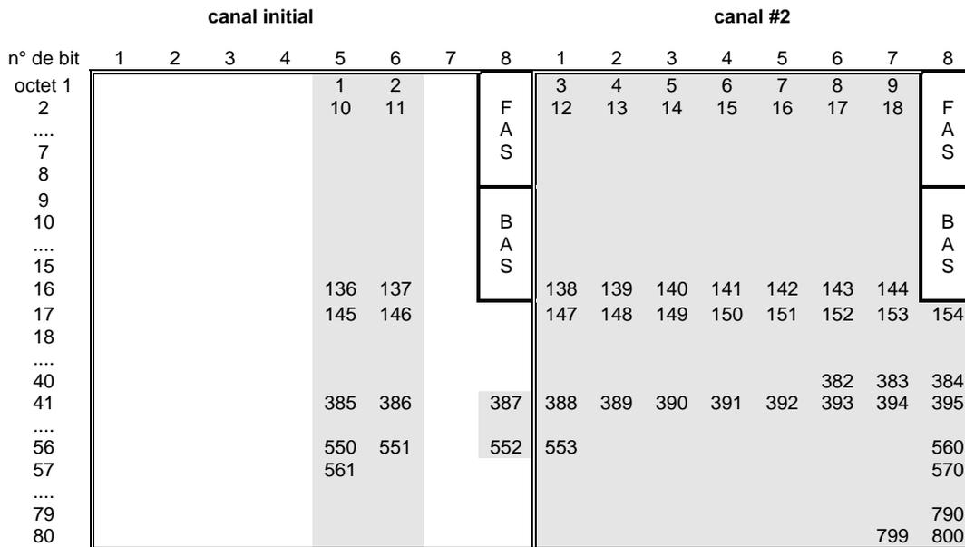
train binaire audio à 80 kbit/s dans deux canaux à 64 kbit/s
