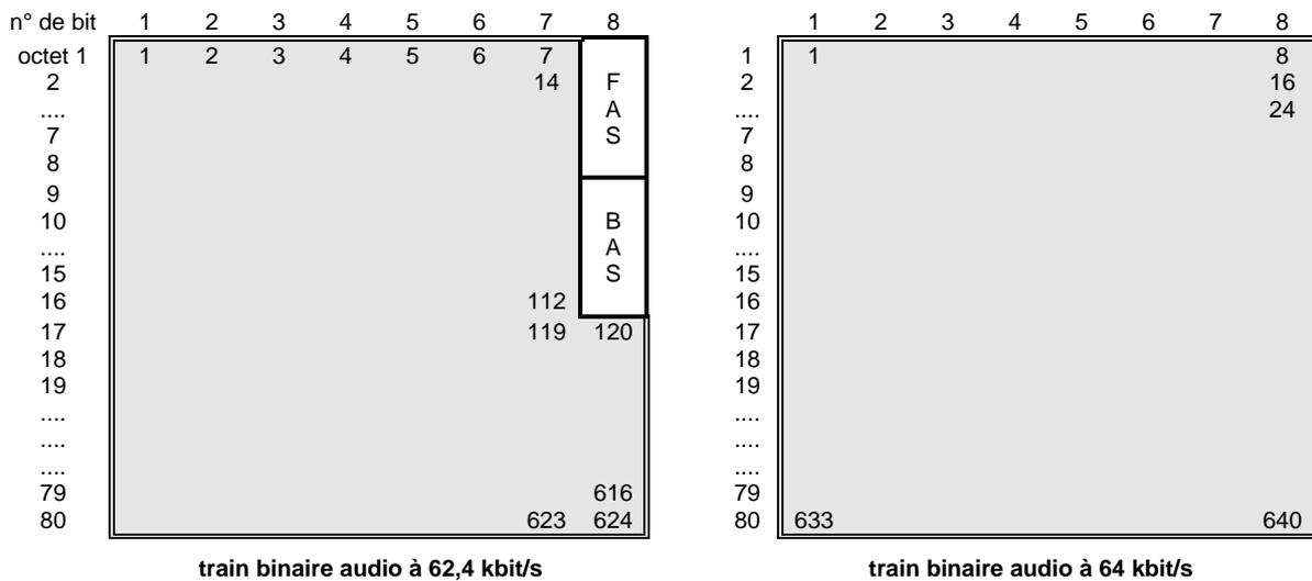
Figure 6/H.221 – Position des bits du train binaire audio codé ISO/CEI 11172-3 dans un ou deux canaux à 64 kbit/s
