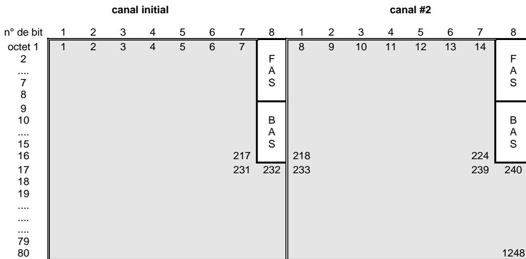
train binaire audio à 124,8 kbit/s dans deux canaux à 64 kbit/s
