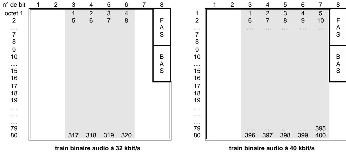
NOTE – Les bits 1 et 2 sont libres afin que le codage G.728 puisse être utilisé simultanément.
