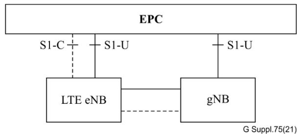
**Figure 34 – Option 3x (Figure 10.1.2.4.1-1 of [b-3GPP TR 38.801])**
