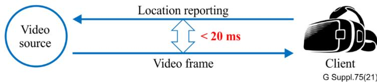
**Figure 15 – MTP RTT or  $2 \times T_{app}$  [b-IETF TS AR&VR]**
