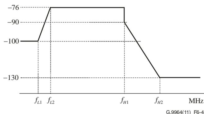
**Figura 6-4 – Máscara de PSD límite de banda base sobre cable coaxial**
