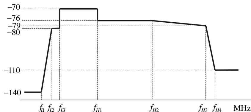
**Figura 6-1.1 – Máscara de PSD límite para la transmisión por líneas telefónicas (no se indican entalladuras de banda de radioaficionados)**
