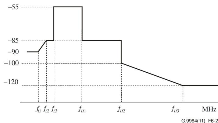
**Figura 6-2 – Máscara de PSD límite para la transmisión de banda base por líneas de energía eléctrica para planes de banda de 25 MHz-PB, 50 MHz-PB y 100 MHz-PB (no se indican entalladuras de banda de radioaficionados)**
