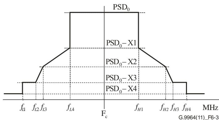
**Figura 6-3 – Máscara de PSD límite monocanal para la transmisión de RF sobre cable coaxial**
