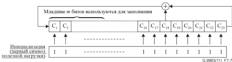
**Рисунок 7-7 – LFSR для модуляции незагруженных и частично загруженных поднесущих каждого из двух пространственных потоков**
