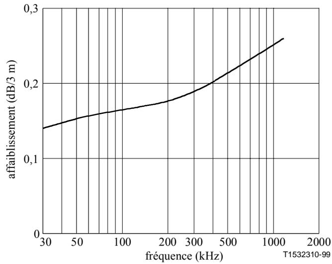
**Figure 48/G.996.1 – Caractéristiques d'affaiblissement d'insertion d'un cordon de raccordement de 3 m**
