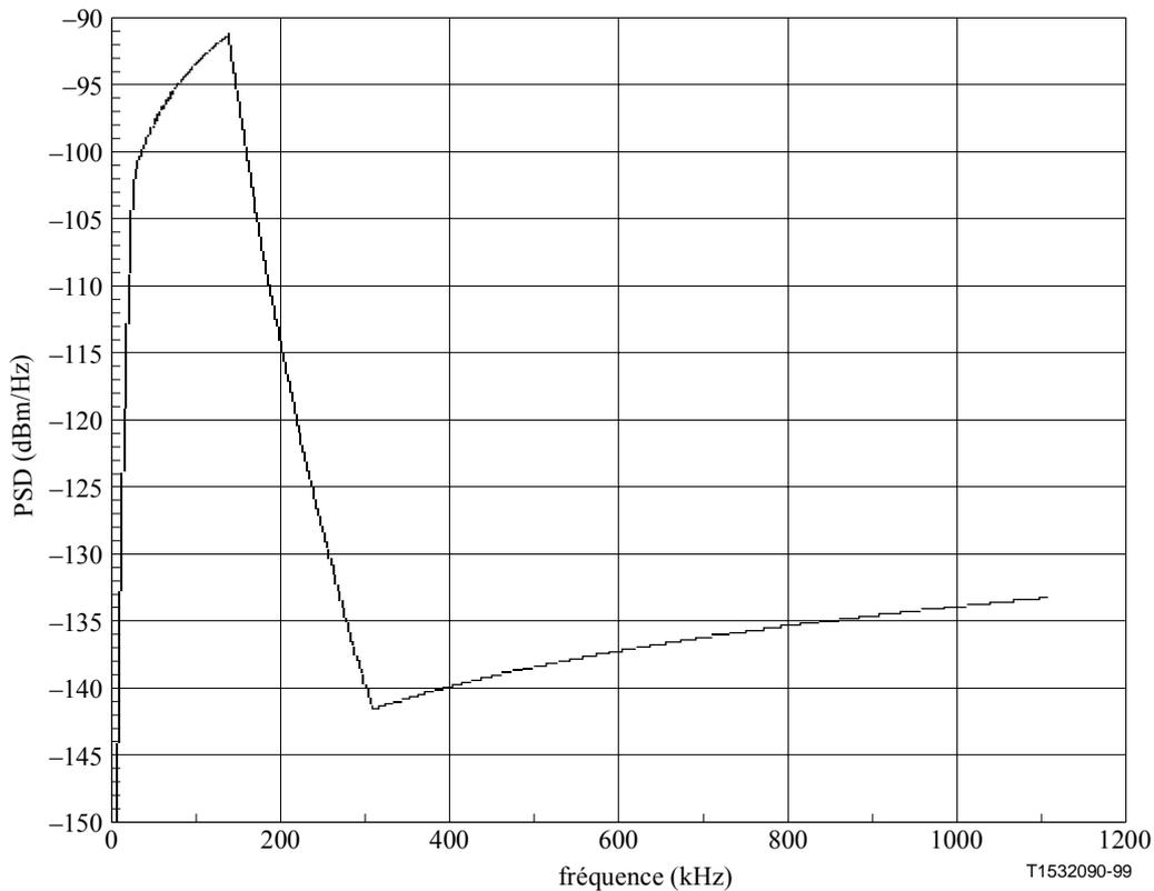
**Figure 26/G.996.1 – Paradiaphonie G.992.2 théorique dans le sens montant due à 49 signaux perturbateurs induite dans le sens descendant**
