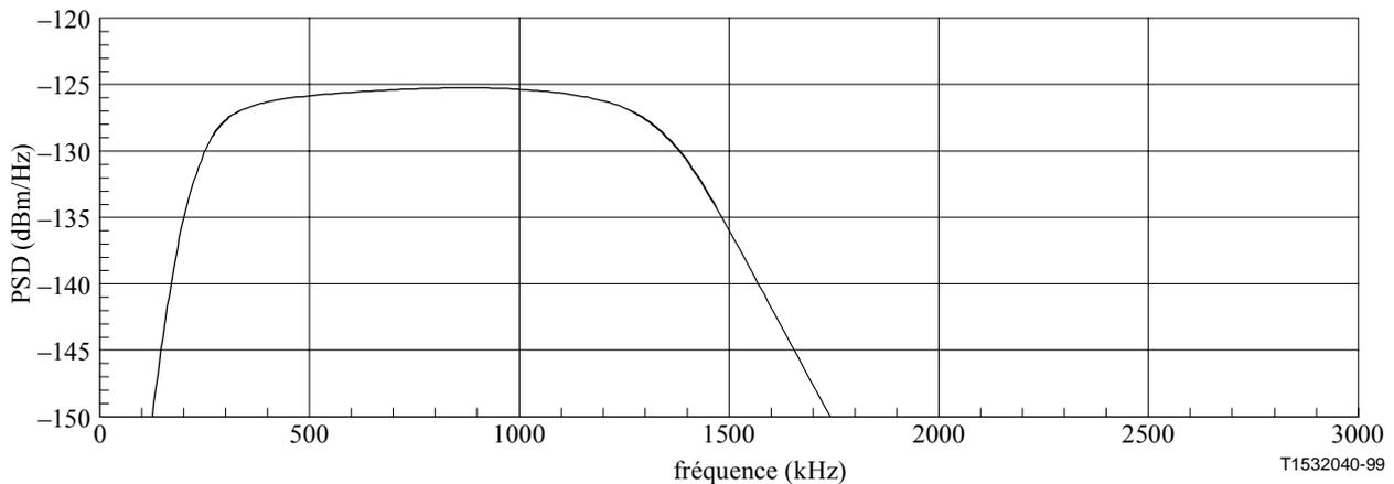
**Figure 21/G.996.1 – Télédiaphonie G.992.1 dans le sens montant due à des signaux perturbateurs sur une boucle C #6**
