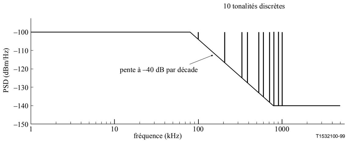
**Figure 27/G.996.1 – Densité spectrale de puissance unilatérale de bruit observée sur 100  $\Omega$  pour le modèle ETSI A**
