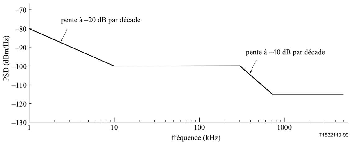
**Figure 28/G.996.1 – Densité spectrale de puissance unilatérale de bruit observée sur 100  $\Omega$  pour le modèle ETSI B**
