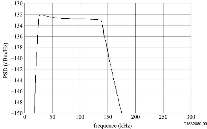
**Figure 25/G.996.1 – Télédiaphonie théorique G.992.2 dans le sens montant due à 49 signaux perturbateurs sur une boucle T #7**
