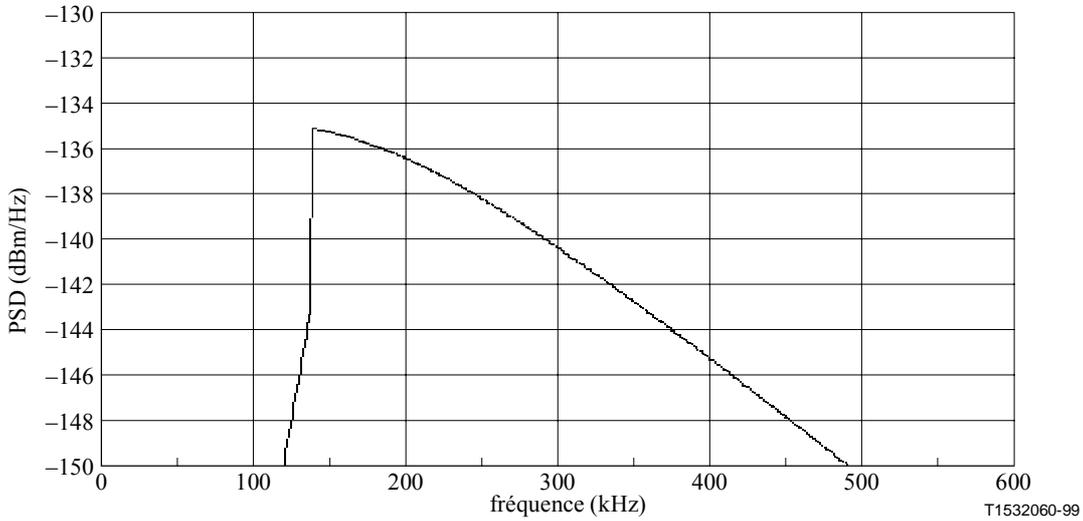
**Figure 23/G.996.1 – Télédiaphonie G.992.2 dans le sens descendant due à 49 signaux perturbateurs sur une boucle T #7**
