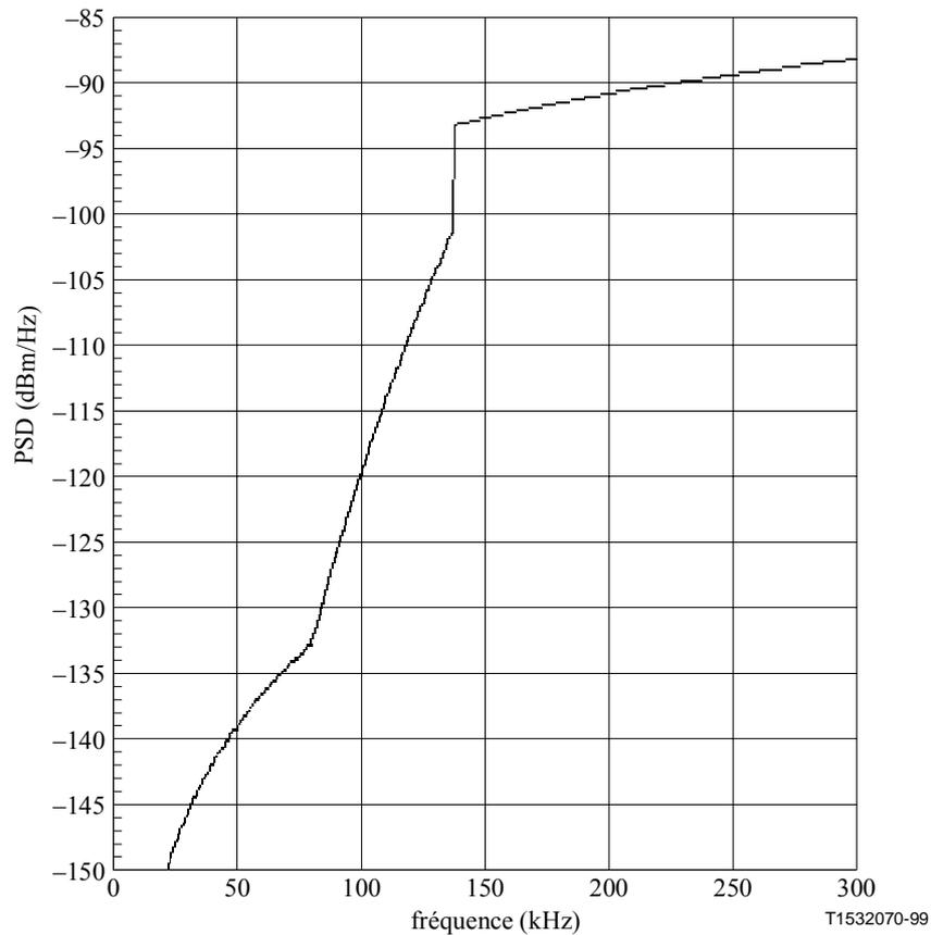
**Figure 24/G.996.1 – Paradiaphonie G.992.2 dans le sens descendant due à 49 signaux perturbateurs induite dans le sens montant**
