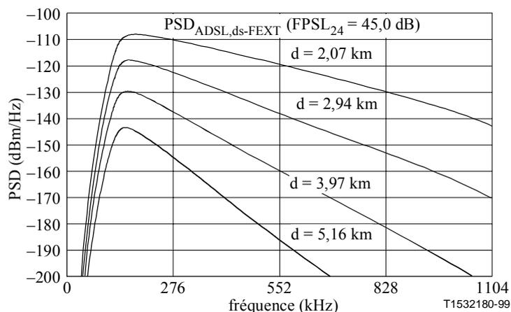
**Figure 35/G.996.1 – Télédiaphonie dans le sens descendant G.992.1 (MRF) due à 24 signaux perturbateurs**
