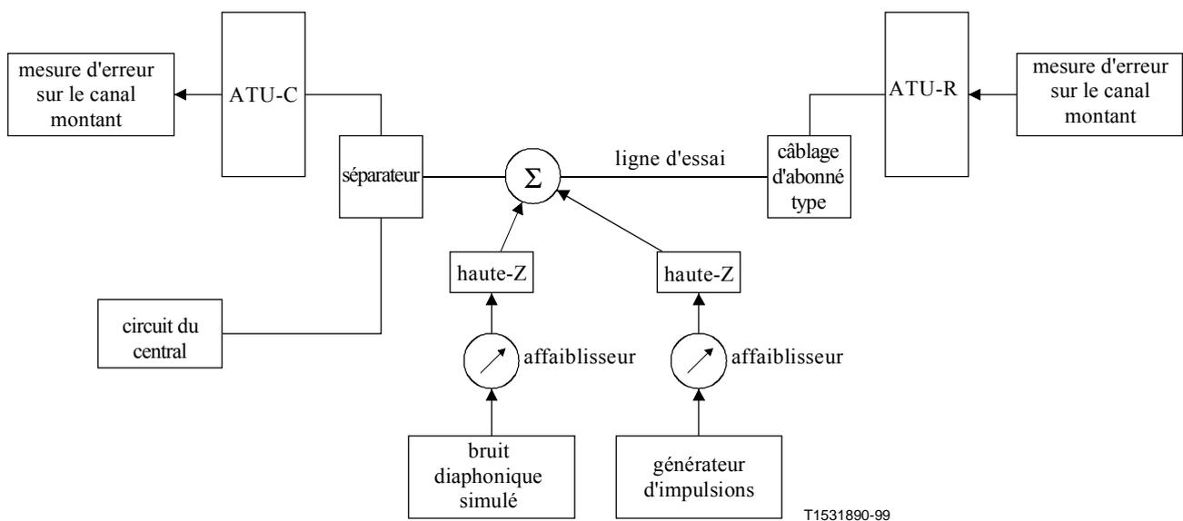
**Figure 6/G.996.1 – Montage d'essai de laboratoire pour mesurer les marges de qualité de fonctionnement sur le canal montant sans séparateur dans l'unité ATU-R**
