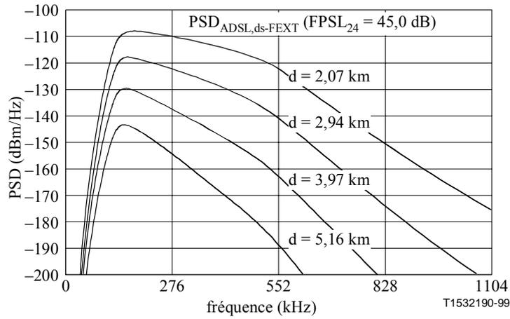
**Figure 36/G.996.1 – Télédiaphonie dans le sens descendant (MRF) G.992.2 due à 24 signaux perturbateurs**
