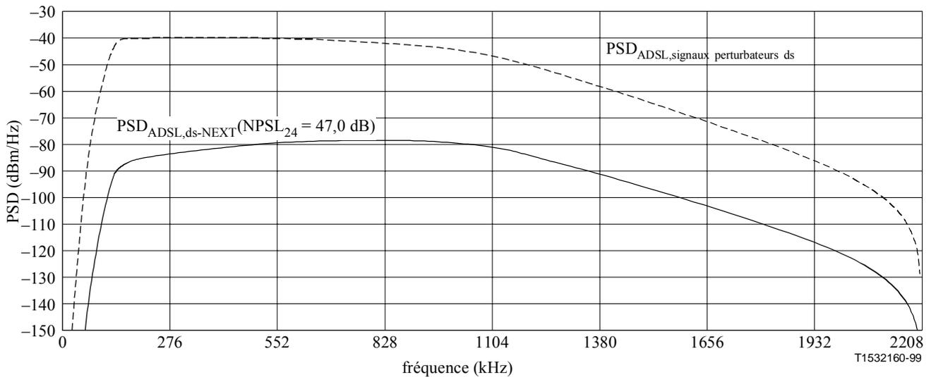
**Figure 33/G.996.1 – Paradiaphonie dans le sens descendant(MRF) G.992.1 due à 24 signaux perturbateurs**
