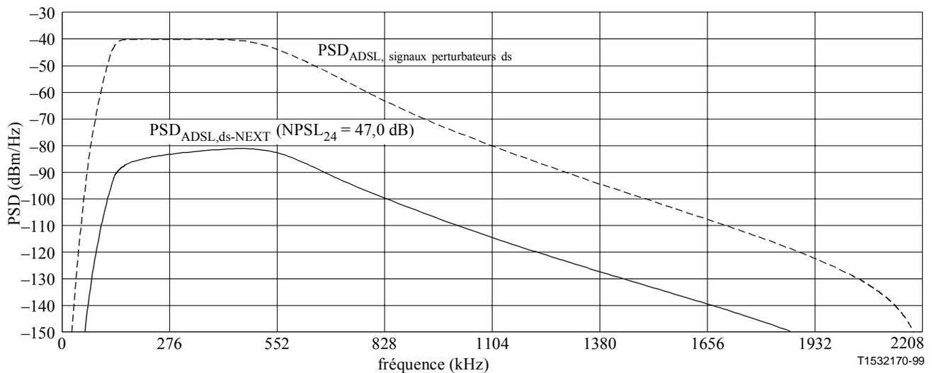
**Figure 34/G.996.1 – Paradiaphonie dans le sens descendant (MRF) G.992.2 due à 24 signaux perturbateurs**
