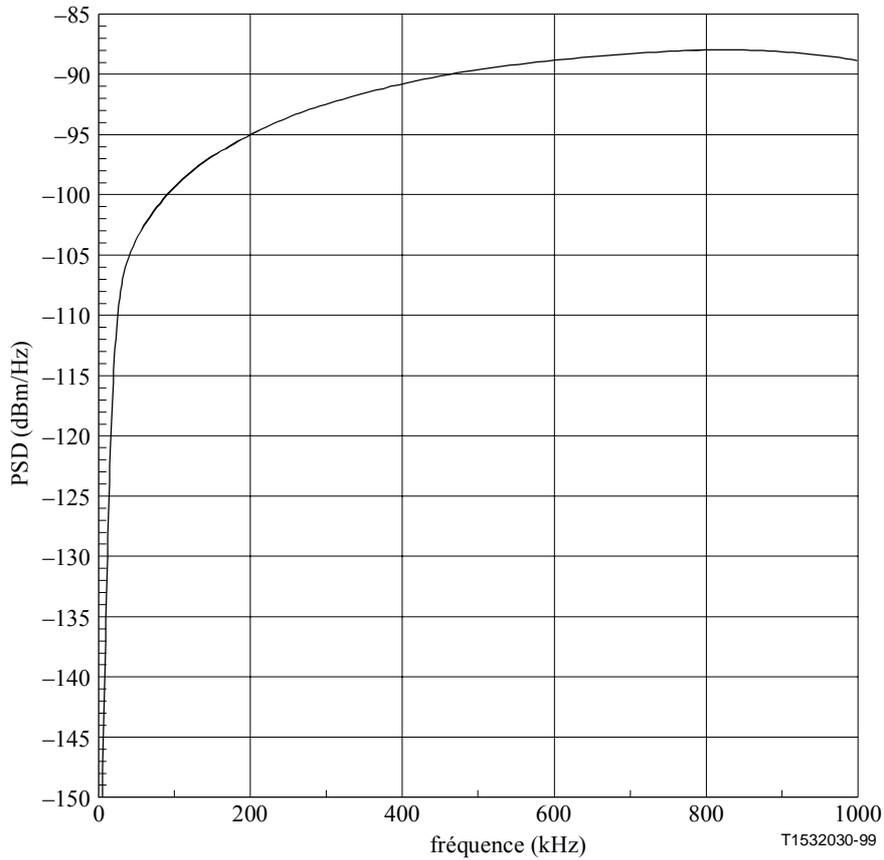
**Figure 20/G.996.1 – Paradiaphonie G.992.1 dans le sens descendant due à dix signaux perturbateurs induite dans le sens montant**
