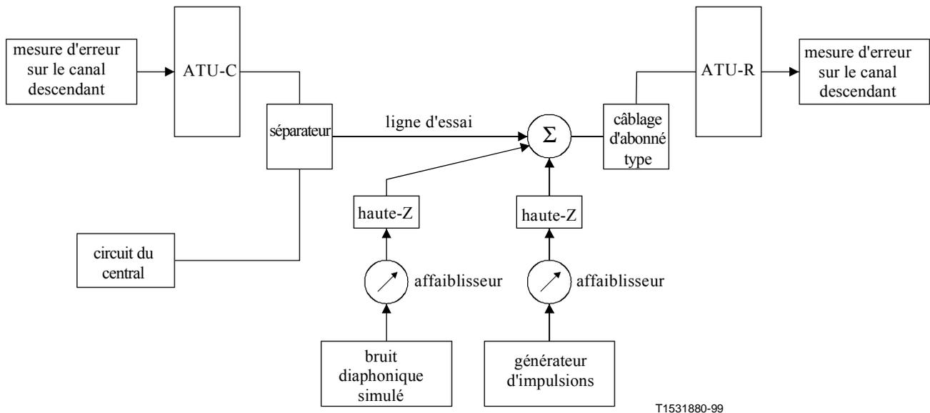
**Figure 5/G.996.1 – Montage d'essai de laboratoire pour mesurer les marges de qualité de fonctionnement sur le canal descendant sans séparateur dans l'unité ATU-R**
