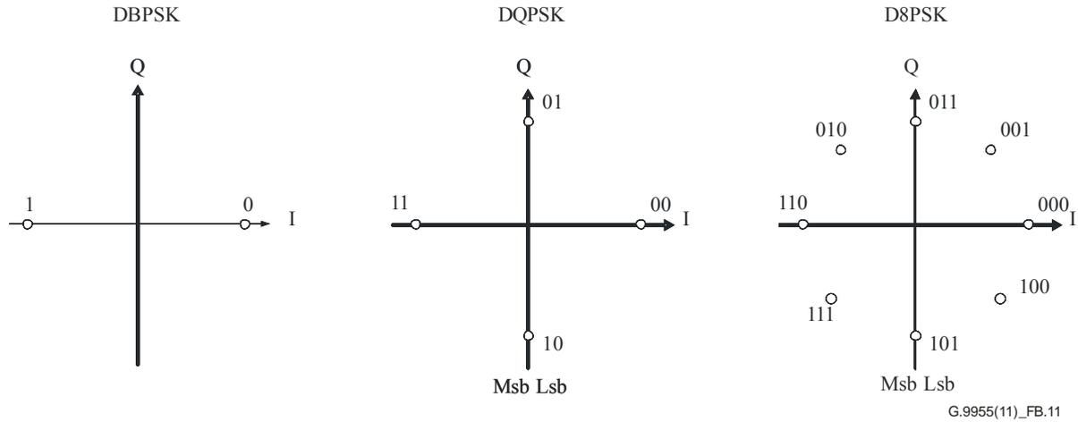
**Figure B.11 – DBPSK, DQPSK and D8PSK mapping**
