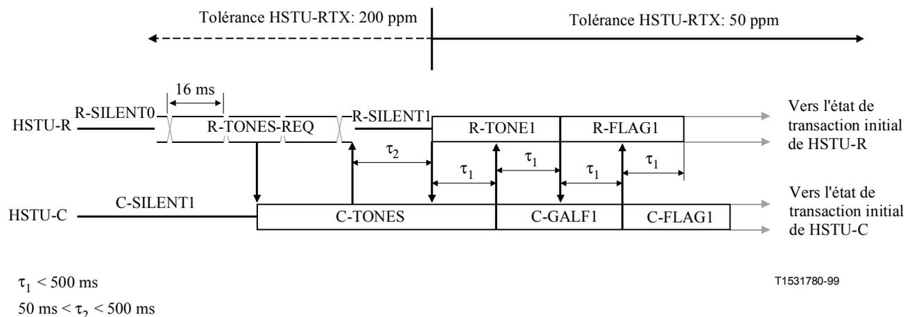
Figure 14/G.994.1 – Procédure de démarrage duplex déclenchée par l'unité HSTU-R
