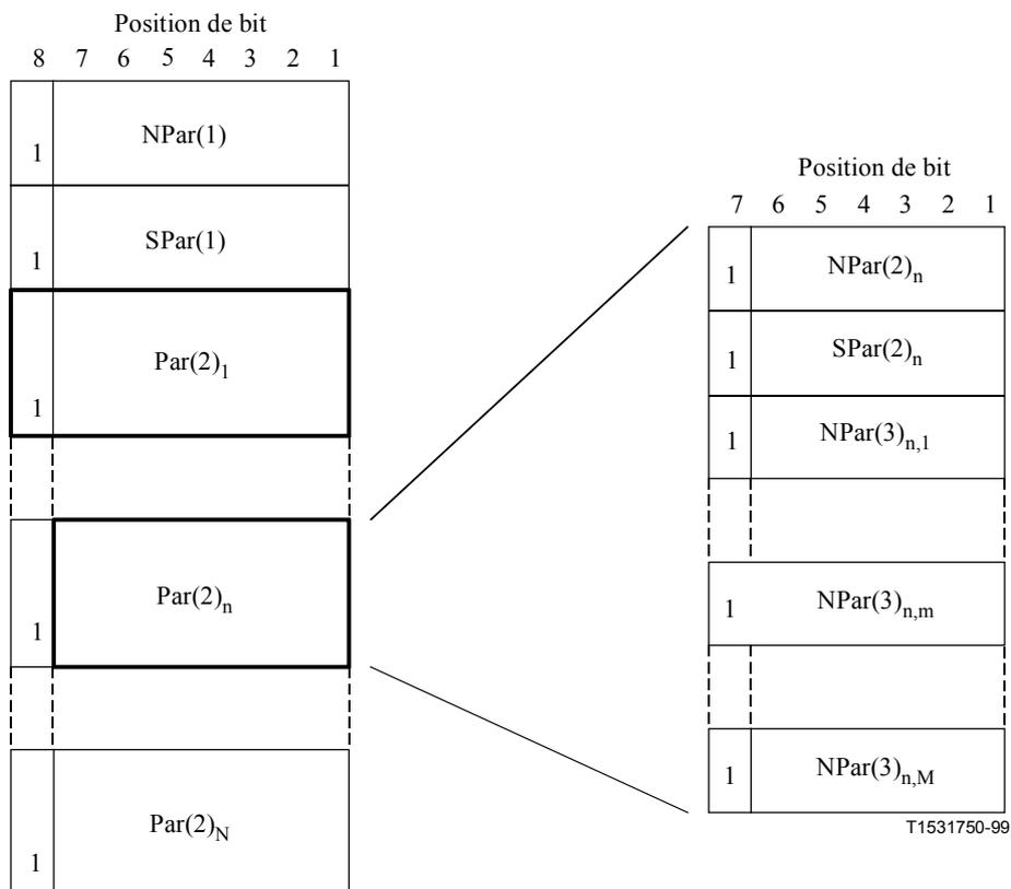
**Figure 8/G.994.1 – Ordre de transmission des paramètres NPar et SPar**
