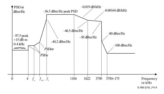
Figure A.6 – VTU-O DS1 limit PSD mask
