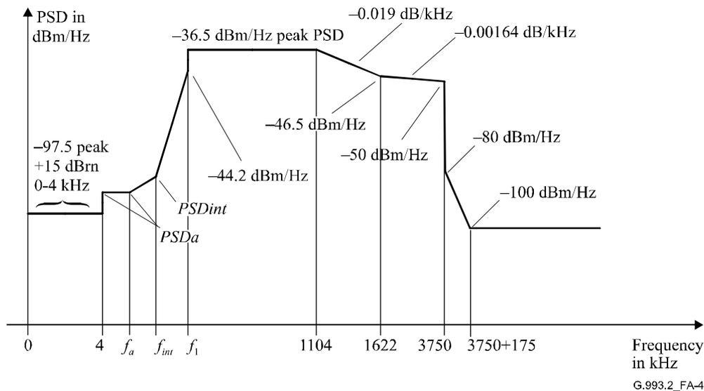
Figure A.4/G.993.2 – VTU-O DS1 transmitter PSD mask
